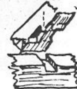
Замок потемочный внакладку
