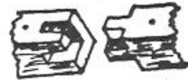
Замок торцевой с двойным боковым шипом
