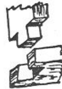
Замок угловой в простой окобородник
