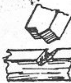
Косой стропильный замок с шипом в затяжке
