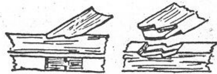
Сложный стропильный замок с двумя зубьями в один шип
