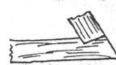
Замок стропильный с обратным зубом и шипом
