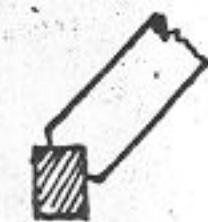
Замок стропильный упорный
