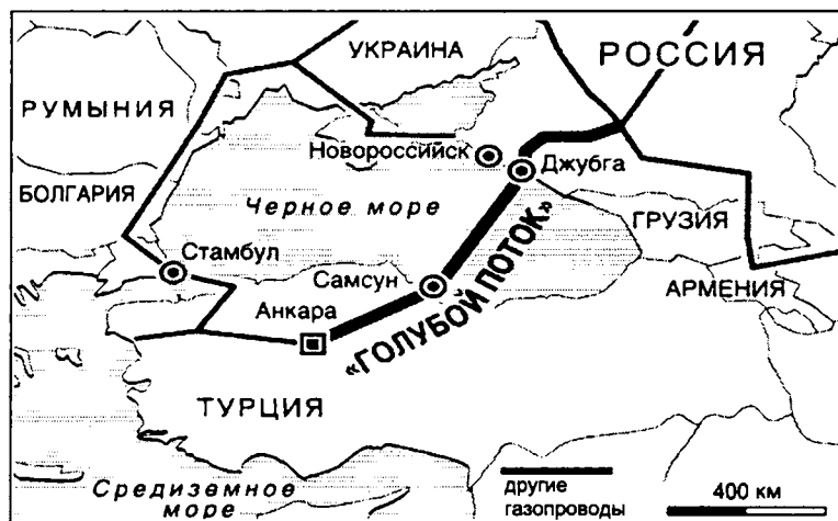
«Голубой поток» – газопровод
