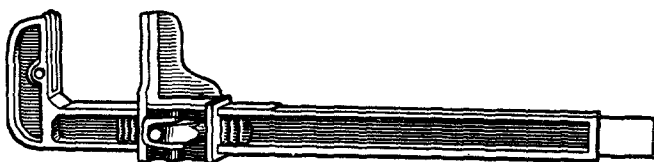
Рис. 104. Adjustable bending bar регулируемое приспособление для правки.
