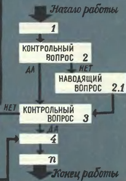
Блок-схема работы обучающей машины «Репетитор» и путь обучения на машине от начала и до конца работы.
