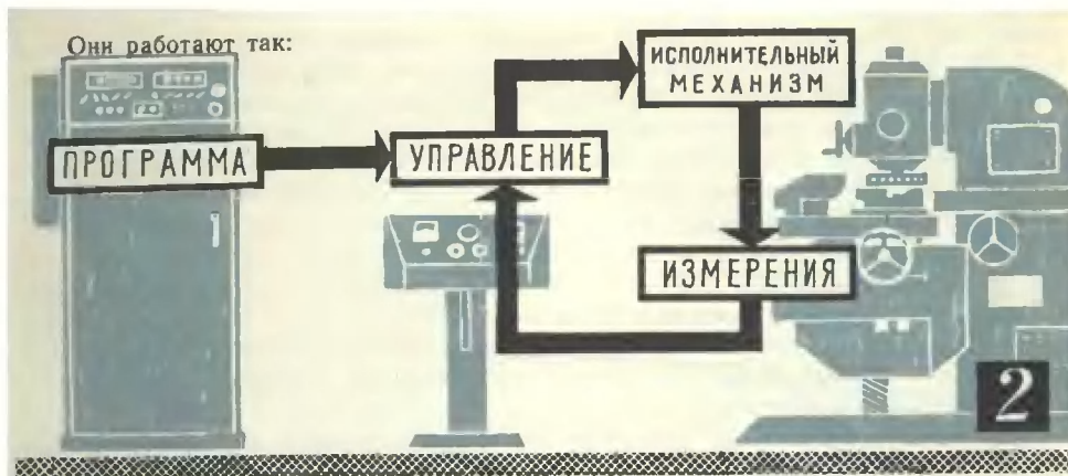
Автомат с замкнутой системой управления.
