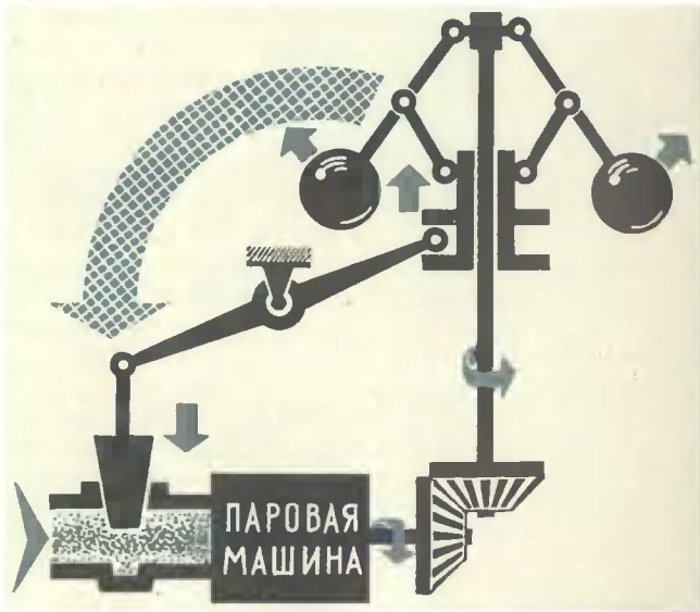
Регулятор Уатта — пример изящества и простоты системы с обратной связью.
