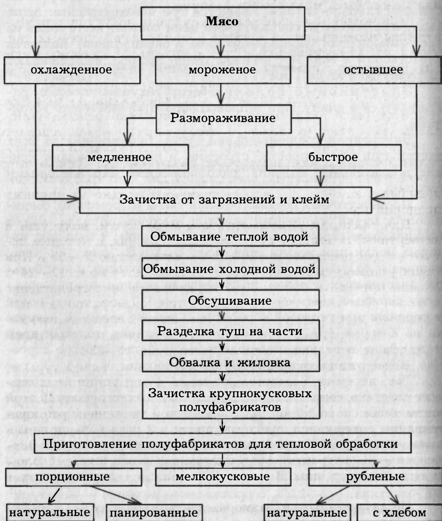
Рис. II.7. Схема механической обработки мяса
