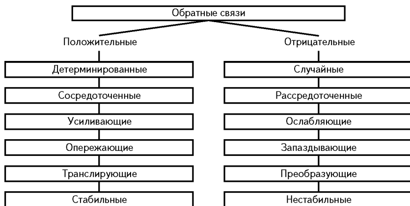
Рис. 2.2. Классификация обратных связей
