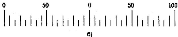
Рис. 28. Шкала линейная: а — с нулевой отметкой слева; б — с нулевой отметкой посередине
