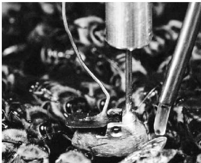
Рис. 1. Пчела-робот и пчелы-фуражиры в искусственном улье. Фотография предоставлена А. Михельсеном (© Centre for Sound Communication, Institute of Biology, Odense University, Denmark. Courtesy of A. Michelsen).
