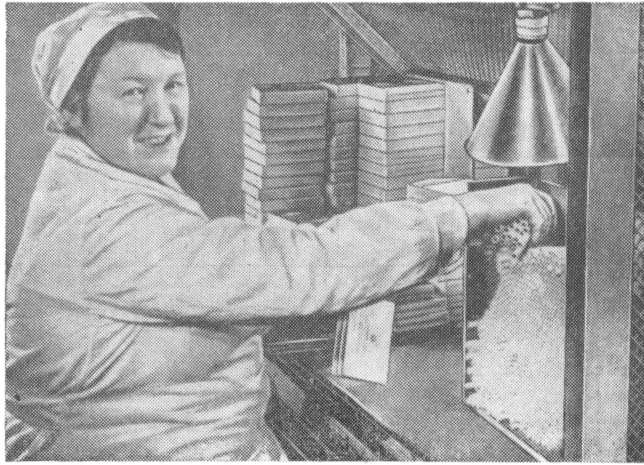
Рис. 66. Совмещение во времени движений правой и левой рук при укладке папирос (кадр из экспериментального фильма).
