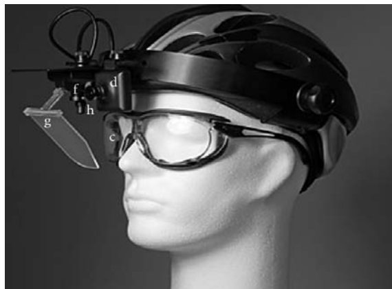
Рис. 1. Айтрекер IView X™ HED SMI в рабочем положении
