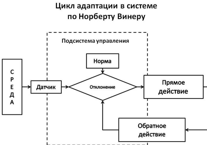
Рис. 1.1. Цикл адаптации системы по Н. Винеру
