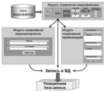
Рис. 12.1. Общая структура программы кодирования данных видеонаблюдения
