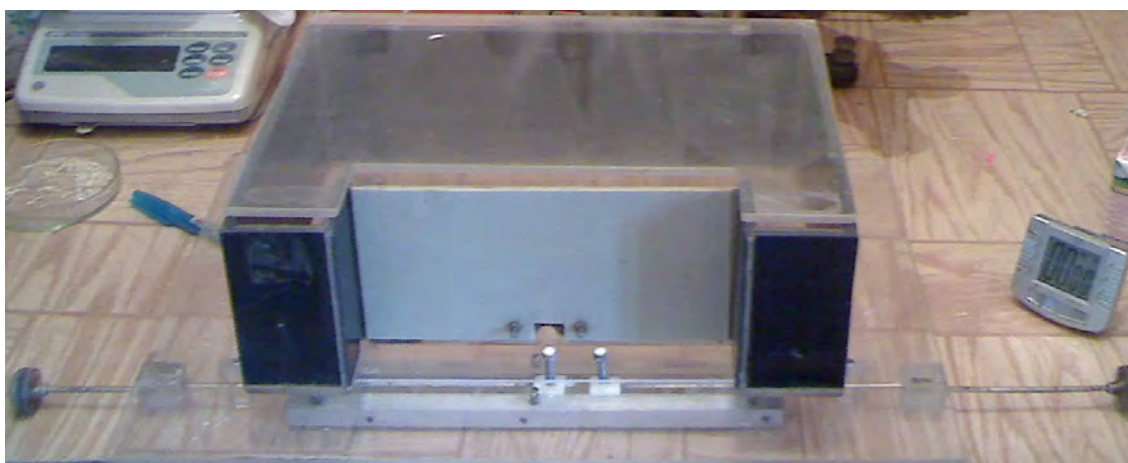
Рисунок 1. Экспериментальная камера для оценки способности мыши к экстраполяции.
