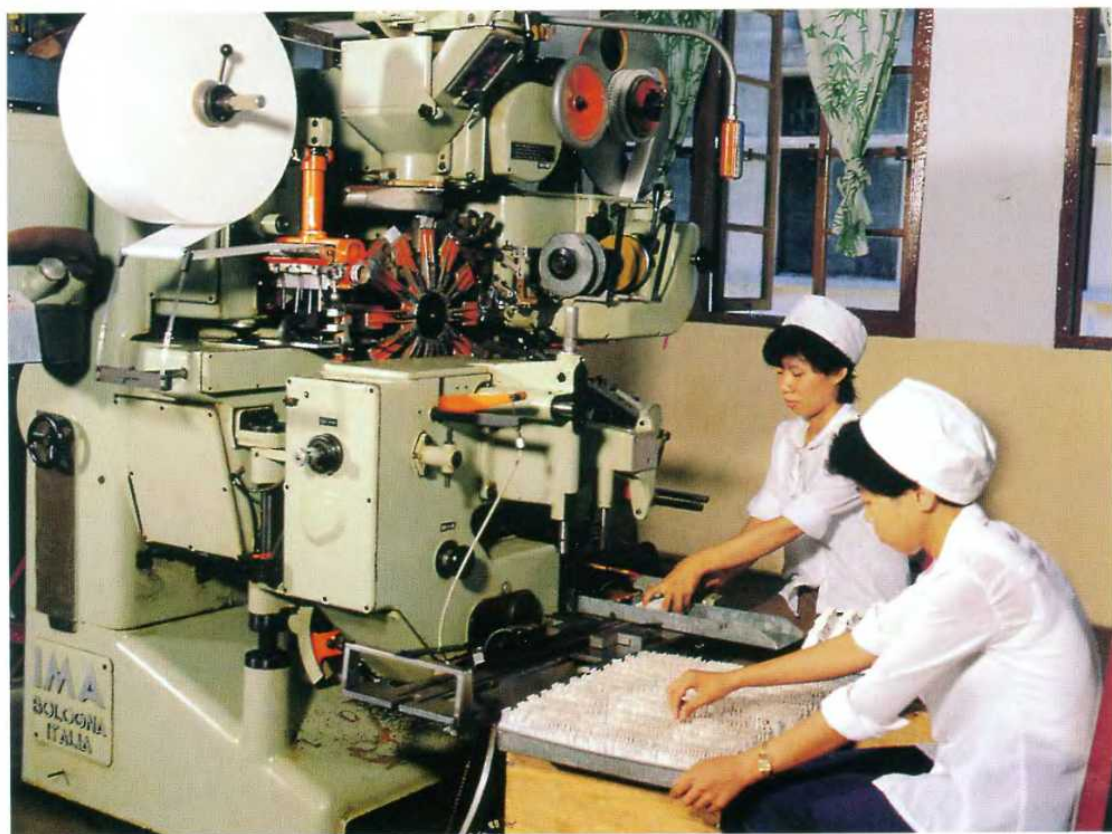
Машина для наполнения пакетиков чая в Китае. Более четверти черного чая в ФРГ пьют, используя пакетики.
