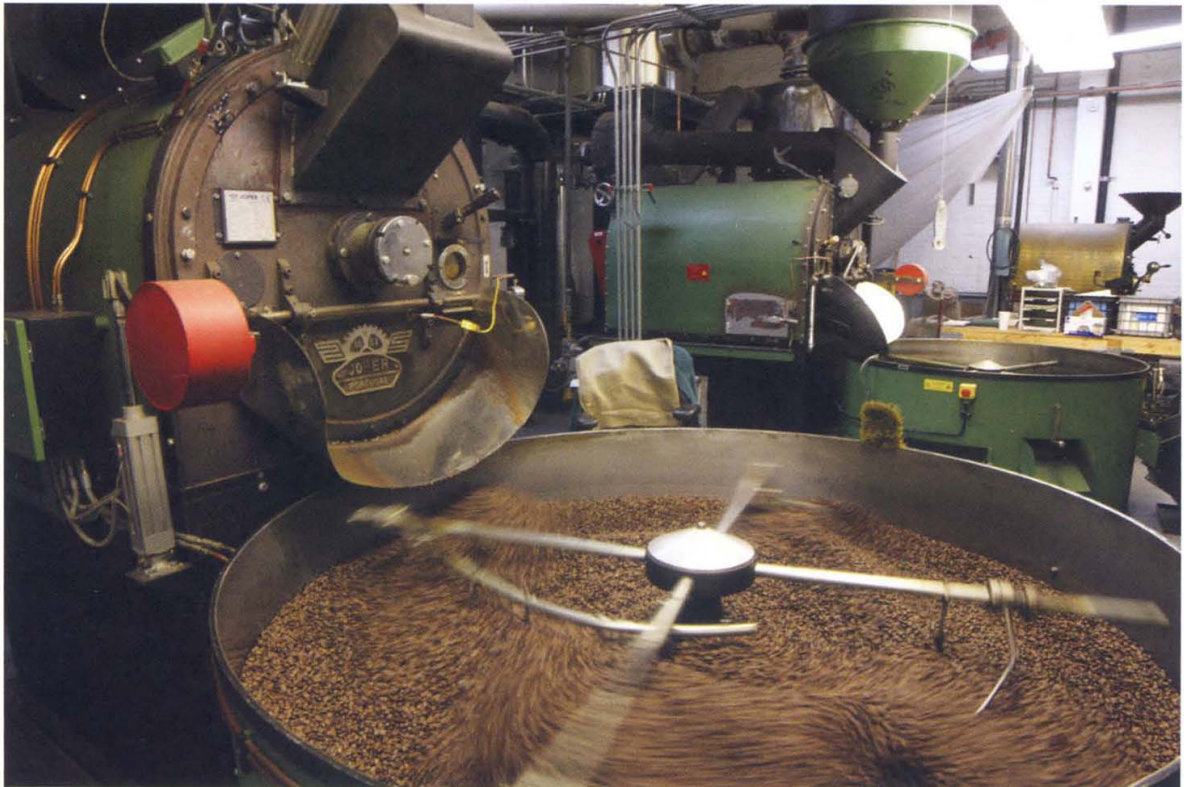
Этот обжарочный аппарат компании «Juper» имеет барабанный рoстер непрямого нагрева.
