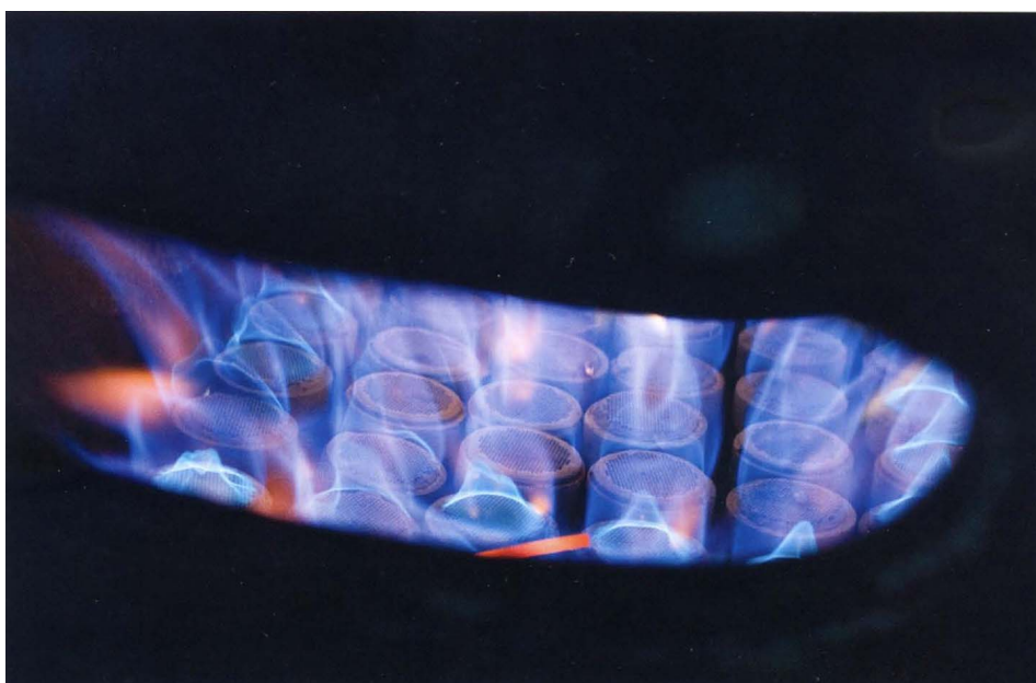
Это пламя имеет идеальное соотношение количества воздуха к количеству топлива в воздушно-топливной смеси.
