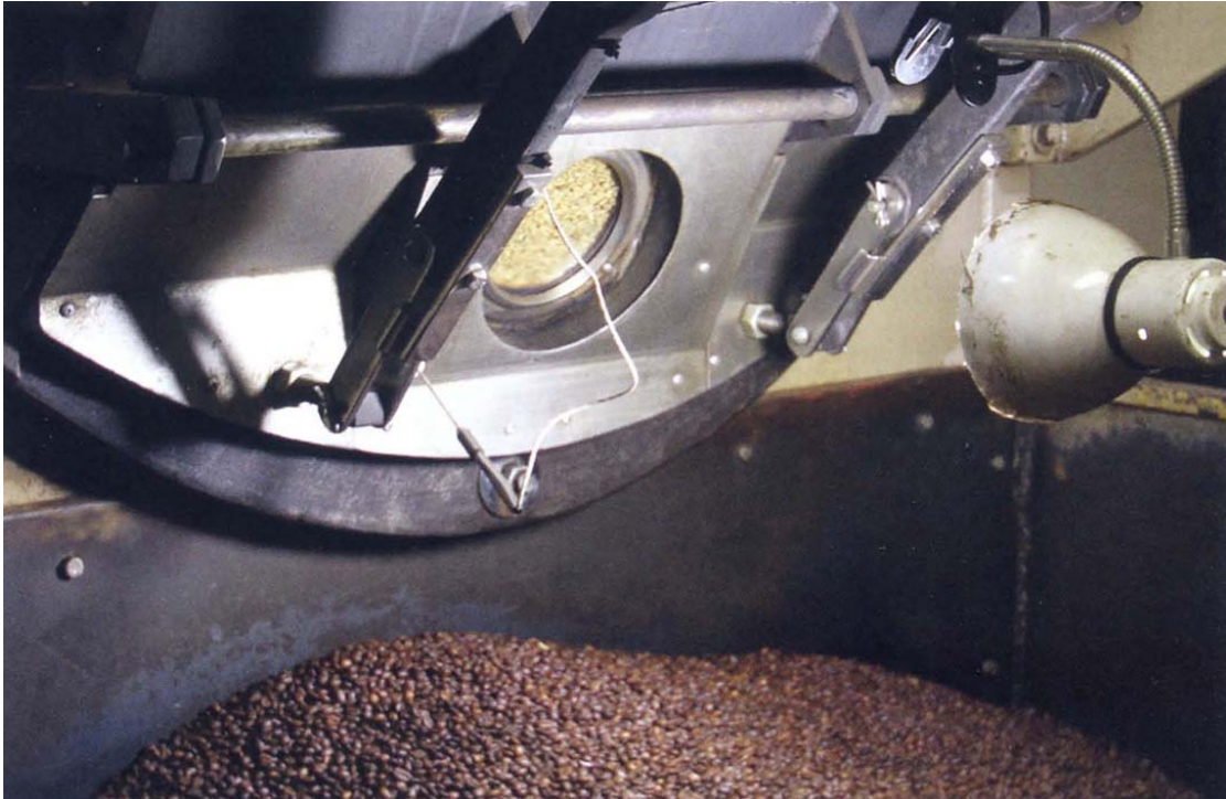
Термодатчик малого диаметра в ростере «Lilla»
