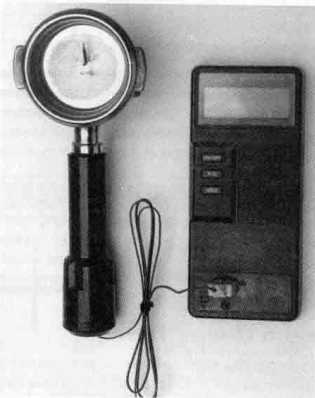
Крохотный термодатчик установлен у самой поверхности сетки портафильтра
