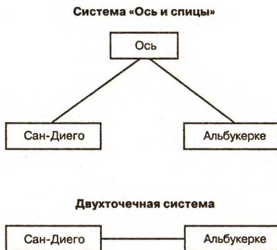
Рис. 9.1. Сравнение системы «ось и спицы» и двухточечной системы
