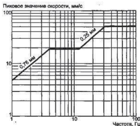
Рис. 78. Предельные значения скорости от ветровой нагрузки в основании [11]
