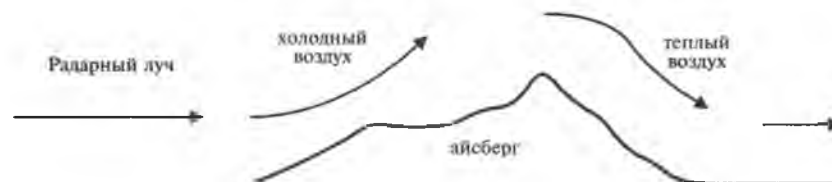
Рисунок 87. При определенных условиях радарный луч не может обнаружить айсберг.
