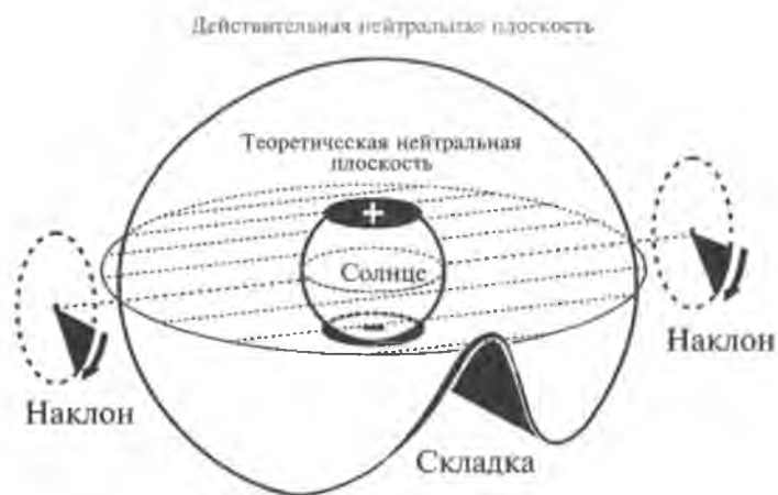
Рисунок А20. На этой диаграмме показано, что проходящая вокруг экватора нейтральная плоскость солнечного магнитного поля (на которой полярность ни северная и ни южная) искривлена. Кроме того, эта область нулевой магнитной активности имеет наклон, и поэтому среди ученых она больше известна как «наклоненная нейтральная плоскость» солнца.
