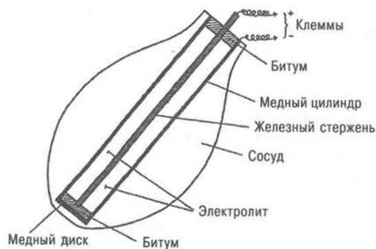
Рис. 16. Схематическое представление копии электрической батареи, найденной американской экспедицией при раскопках в Месопотамии
