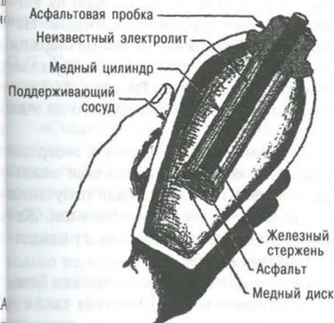
Рис. 15. Модель разреза парфянской батареи, изготовленной Греем в 1940 году для выставки в Беркширском музее
