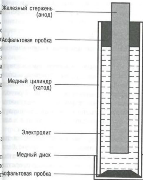
Рис. 10. Расположение железного стержня (анод) и медного цилиндра (катод) в аппарате, найденном в Худжут Рабуа
