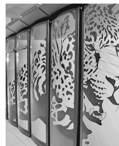
Cray XT5 (Jaguar) — суперкомпьютер класса massively-parallel систем, размещен в Национальном центре компьютерных исследований Министерства энергетики США в Оук-Ридже, штат Теннесси.
