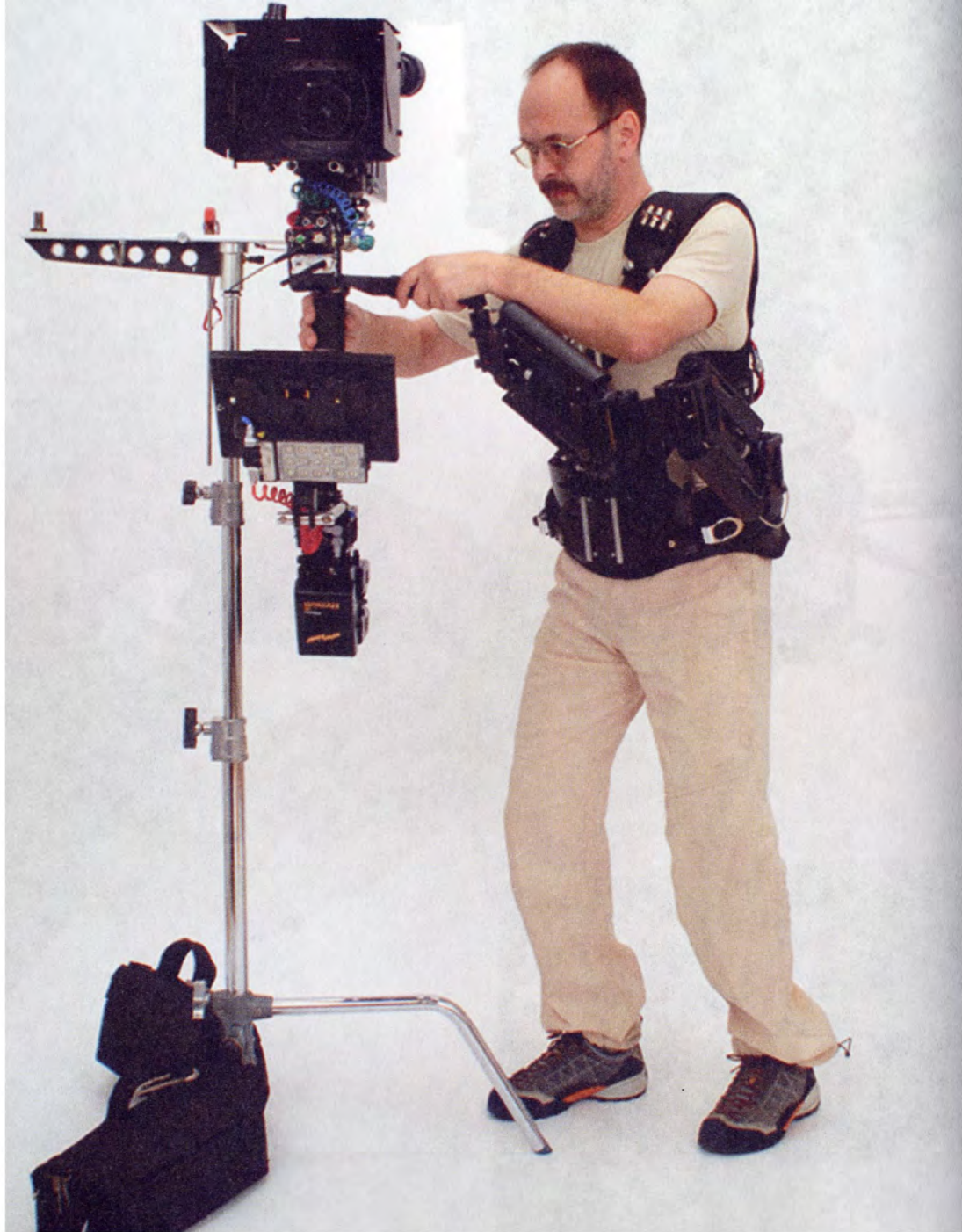
Рис.7-01-9. Беремся правой рукой за рукоятку кардана и, слегка сгибая ноги и выпрямляя при этом корпус, принимаем на себя массу консоли.
