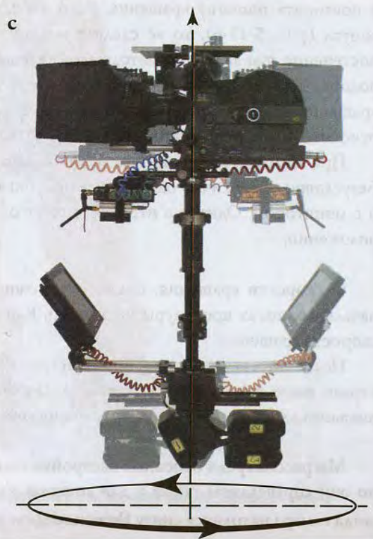
Рис.5-11-б. Настройка динамического баланса. Батарею необходимо выдвинуть.
