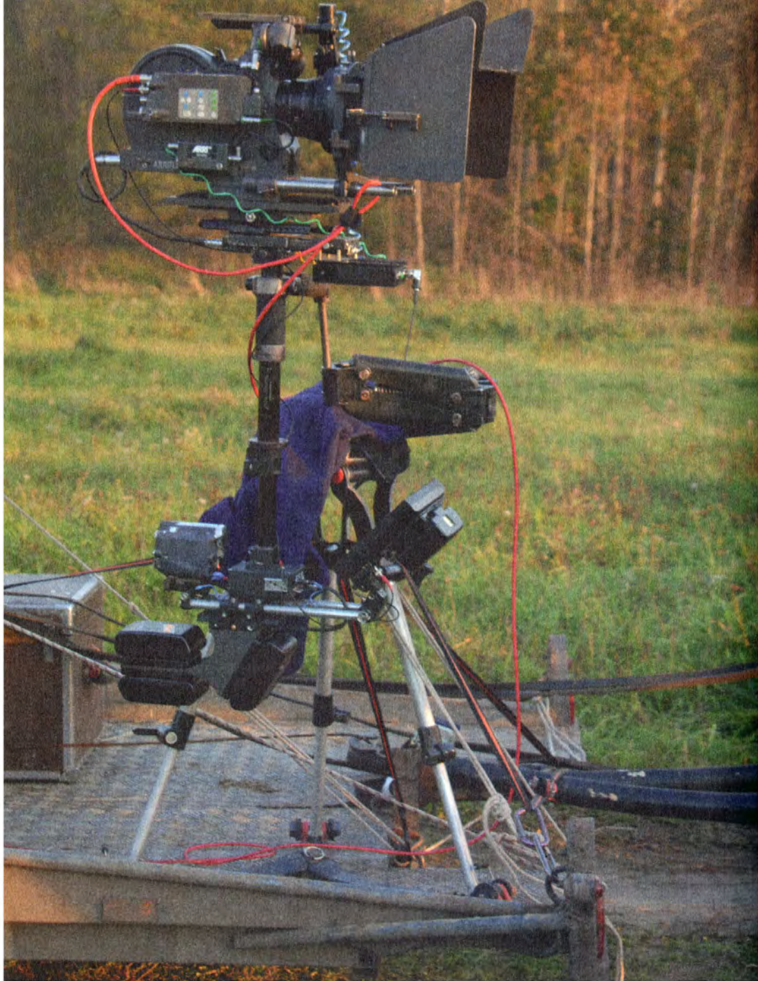
Рис.10-08. Жесткое крепление стедикама на автомобильном прицепе.
