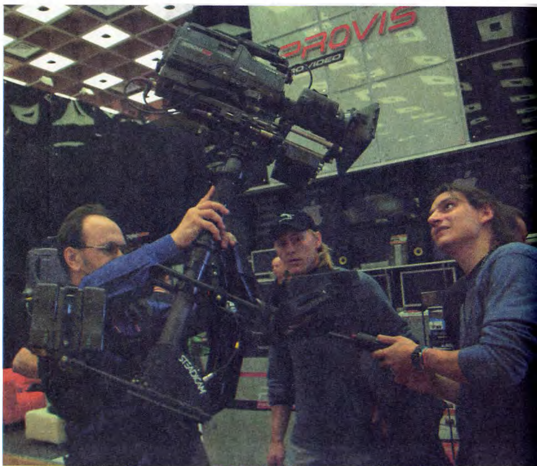
Рис.4-09. Верхнее положение консоли при работе со стедикамом Ultra2.
