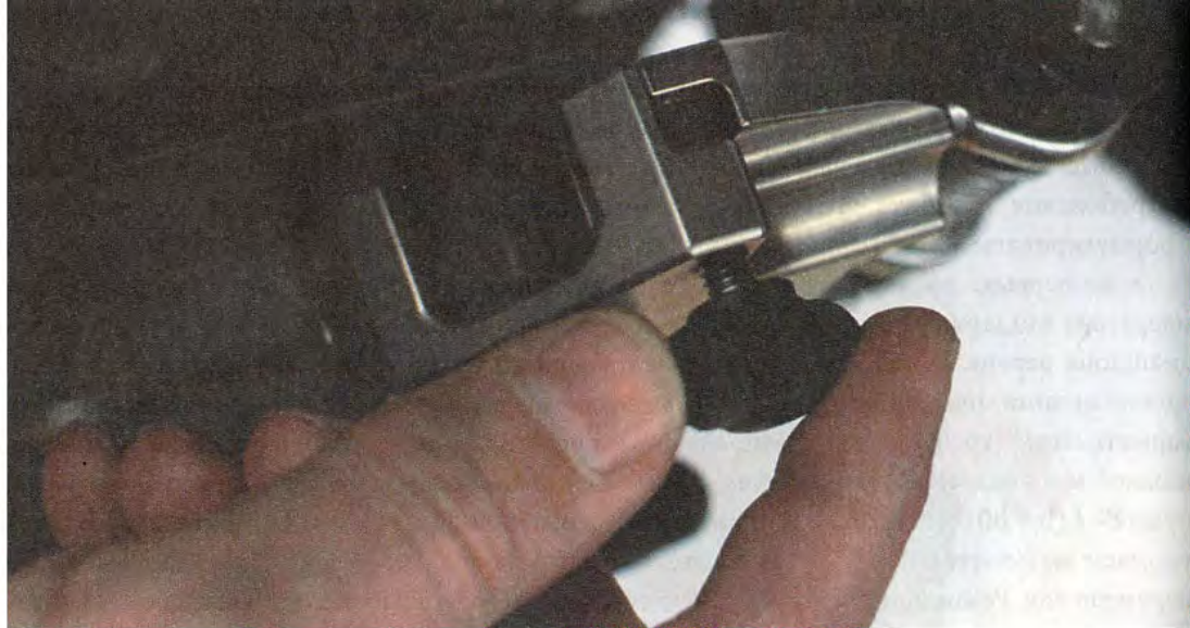
Рис.5-10-в. Регулируем наклон руки-амортизатора «вперед-назад» вращением опорных винтов.
