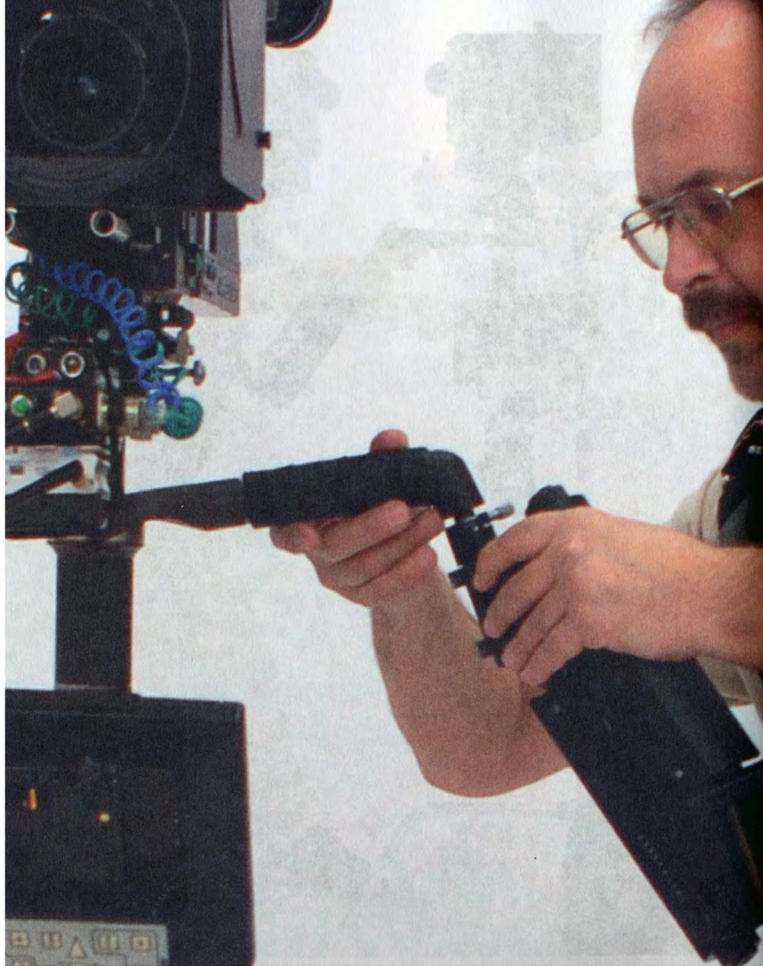
Рис.7-01-7. Оси пальца руки-амортизатора и посадочного отверстия рукоятки при соединении должны совпадать.
