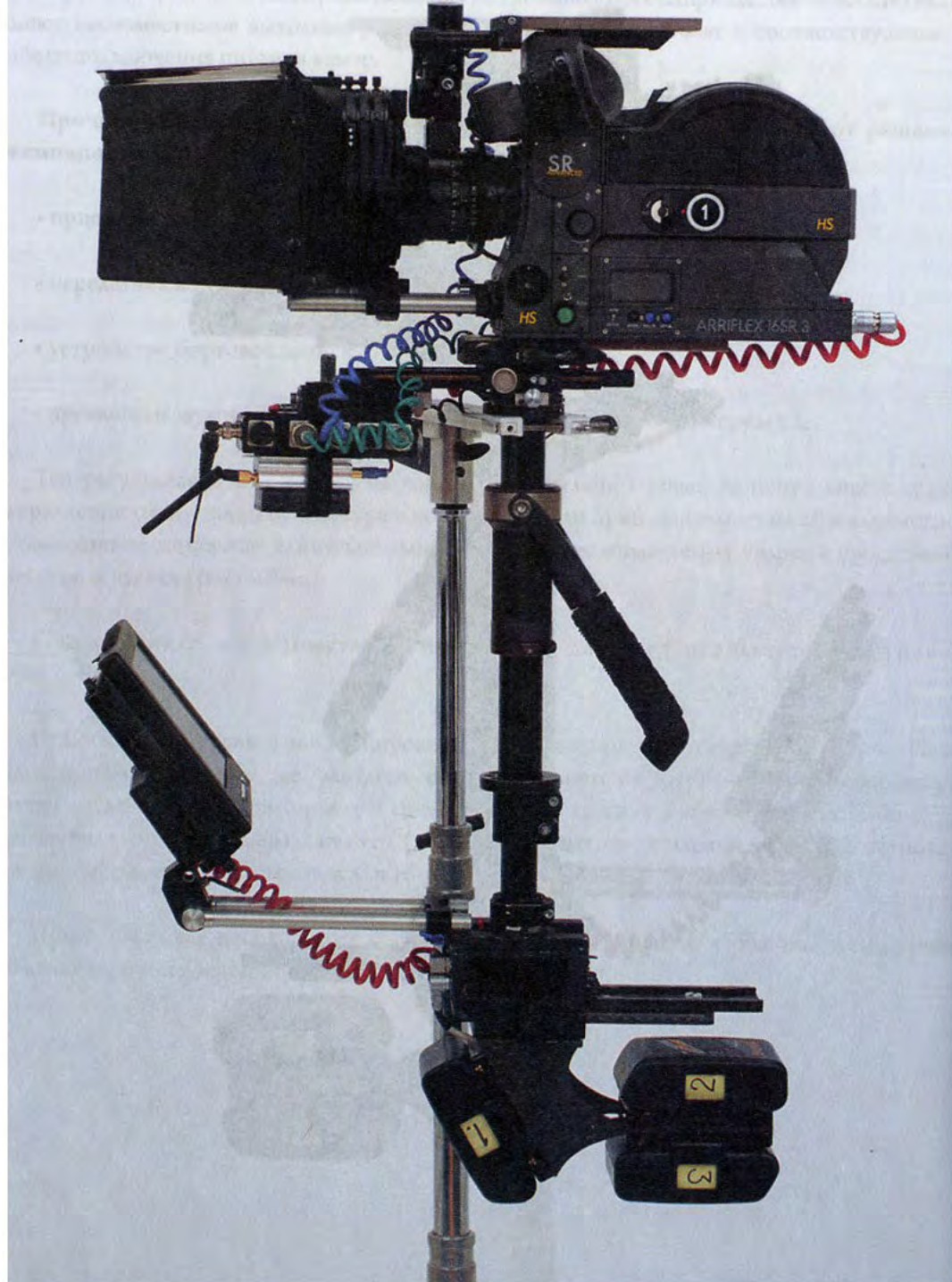
Рис.5-06-в. Присоедините все используемые устройства и все коммутационные кабели.
