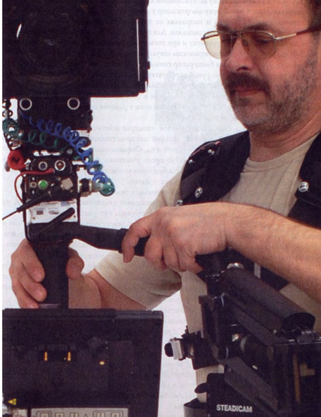
Рис.7-01-10. Выводим консоль из гнезда кронштейна.
