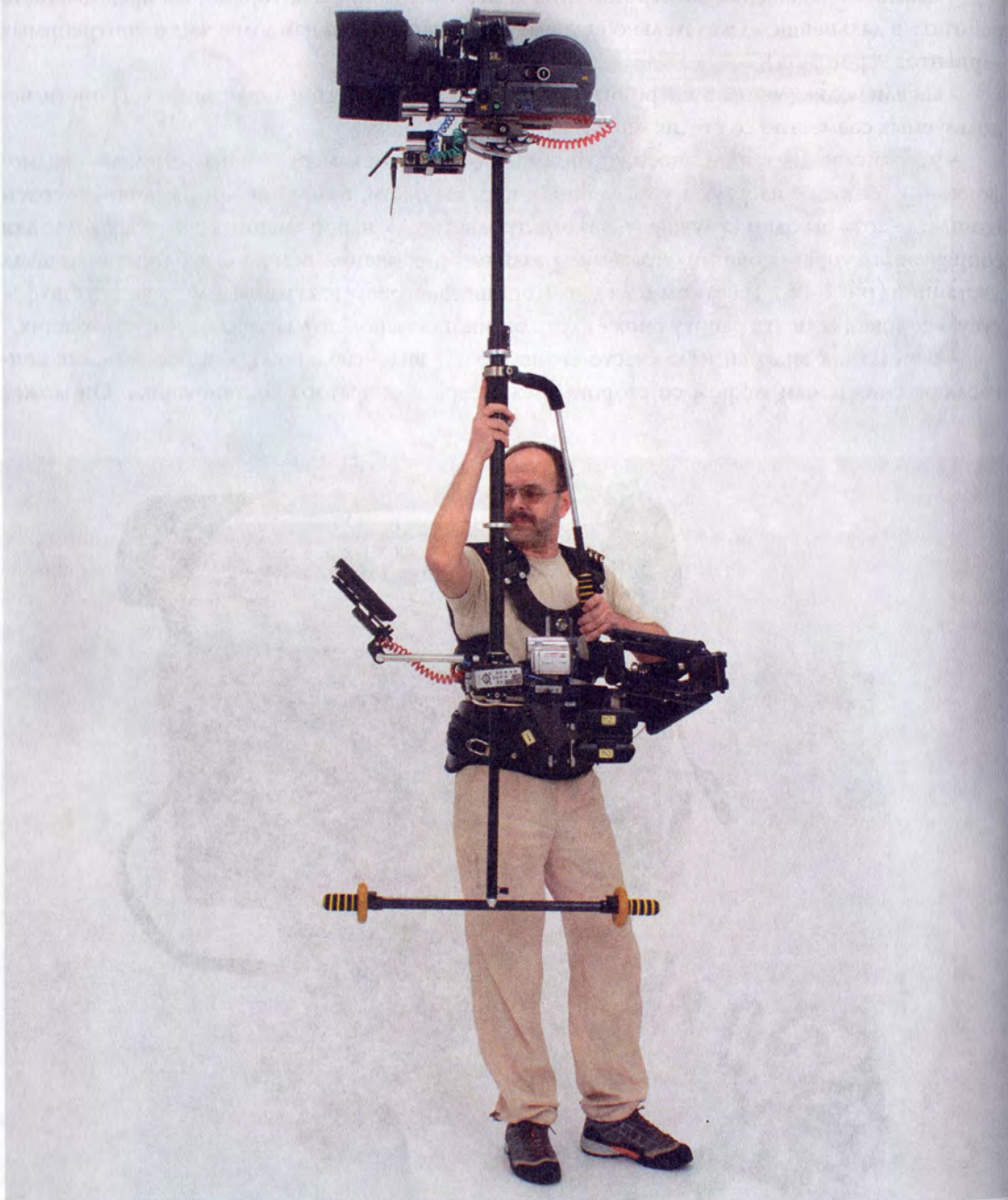
Рис.6-09. Консоль увеличенной длины «суперпост» - для обеспечения особо высоких точек съемки. При этом возможно поднять ось объектива на высоту 2,5-3 метра над уровнем земли. Здесь дополнительно в качестве противовеса используется система Антлерс с массами 1,8 кг удлинительный несущий палец руки-амортизатора длиной 500 миллиметров. Позиция «дон-жуан».
