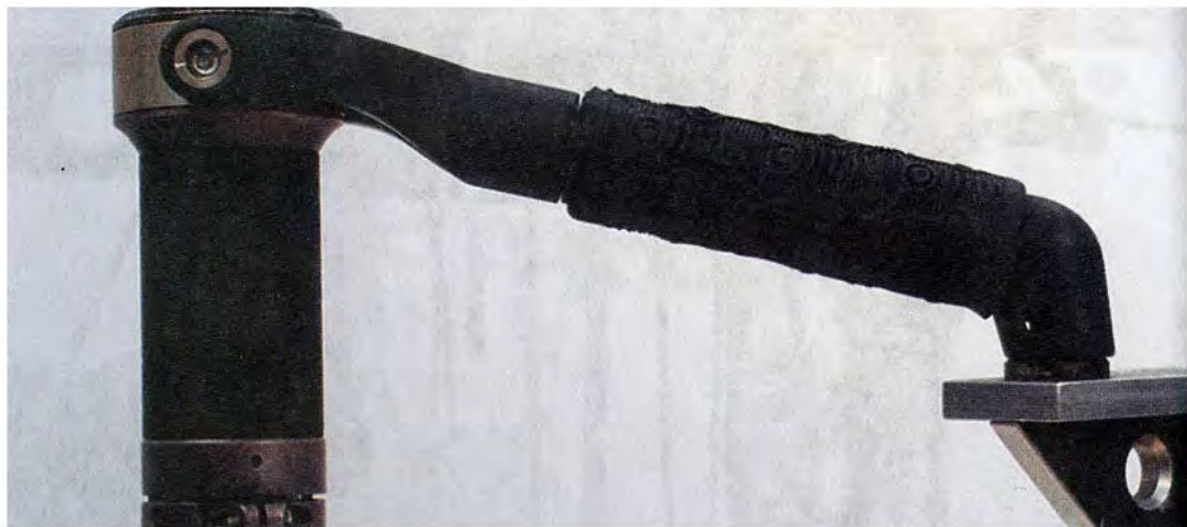
Рис.5-07-а. Консоль с камерой установленная на балансирующий палец кронштейна.
