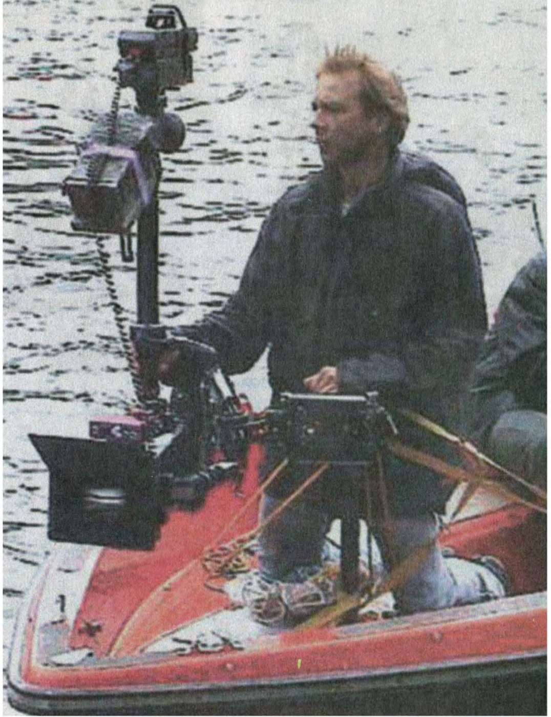
Рис.10-09. Жесткое крепление стедикама на катере (оператор S.Biebl)
