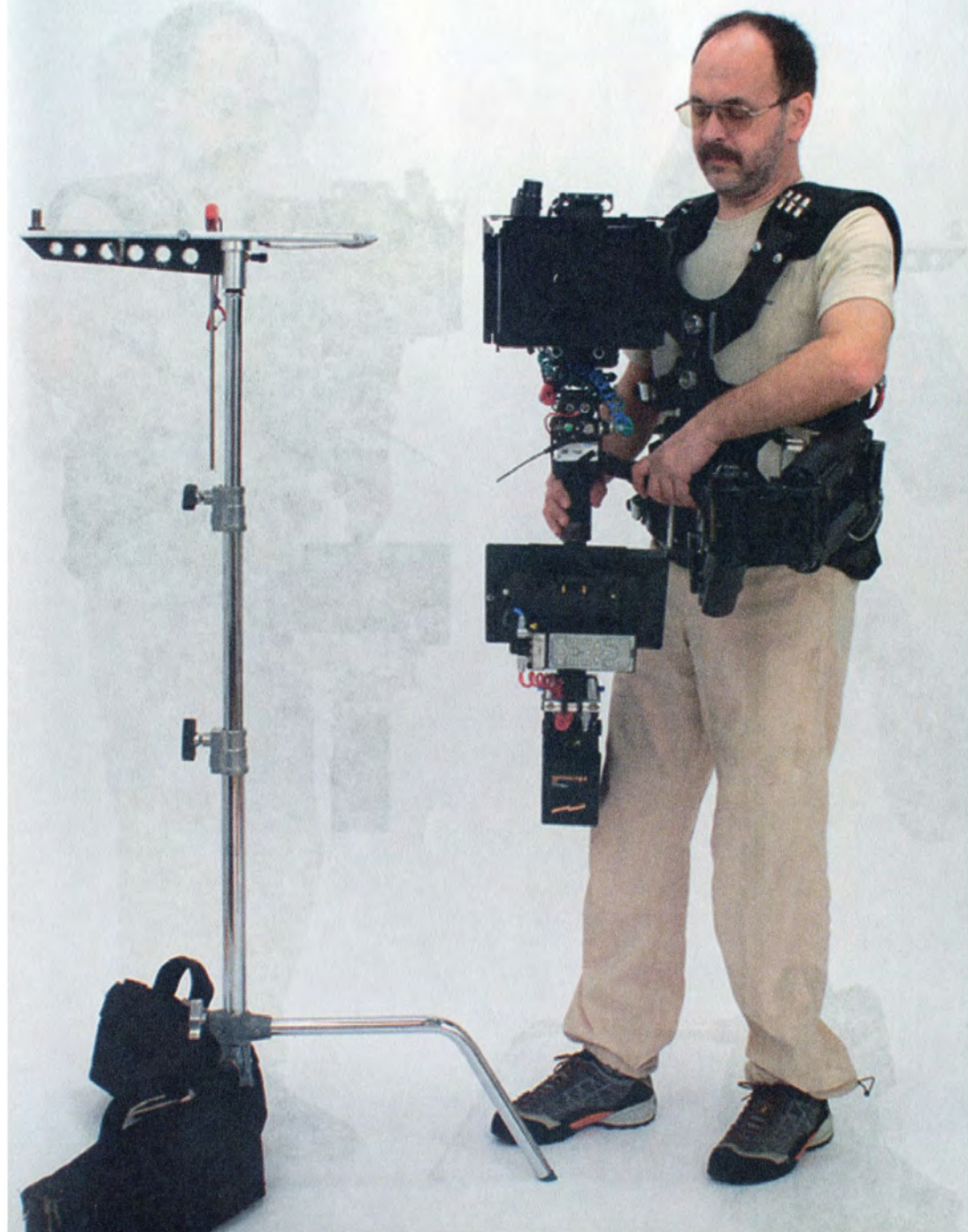
Рис.7-01-11. Перемещаем консоль ближе к себе для удобства поддержания массы всей конструкции.
