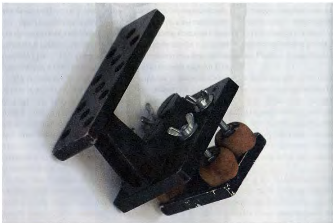
Рис.5-19. Специальный быстро устанавливаемый кронштейн с зажимной трубциной - для видеокамер с достаточно прочными верхними ручками.
