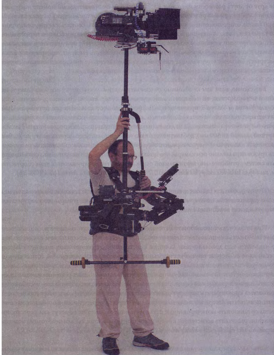
Рис. 4-03-а. Сверхвысокая точка положения камеры. Консоль «супер-пост», в качестве дополнительного противовеса использована система Антлерс.
