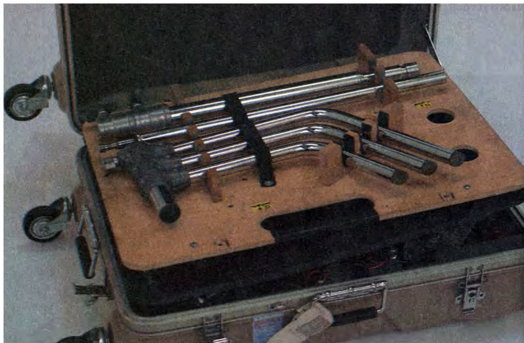
Рис.5-03. Сборочный штатив «си-стенд» («c-stand»), компактно укладываемый в кофр для транспортировки.
