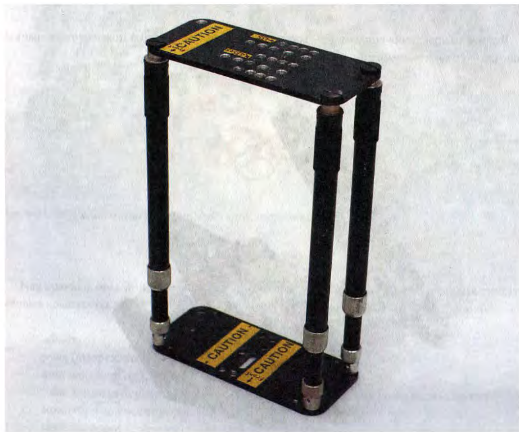
Рис.5-18. Я пользуюсь простейшей разборной конструкцией клетки для нижней точки с телескопически регулируемыми по длине стойками.
