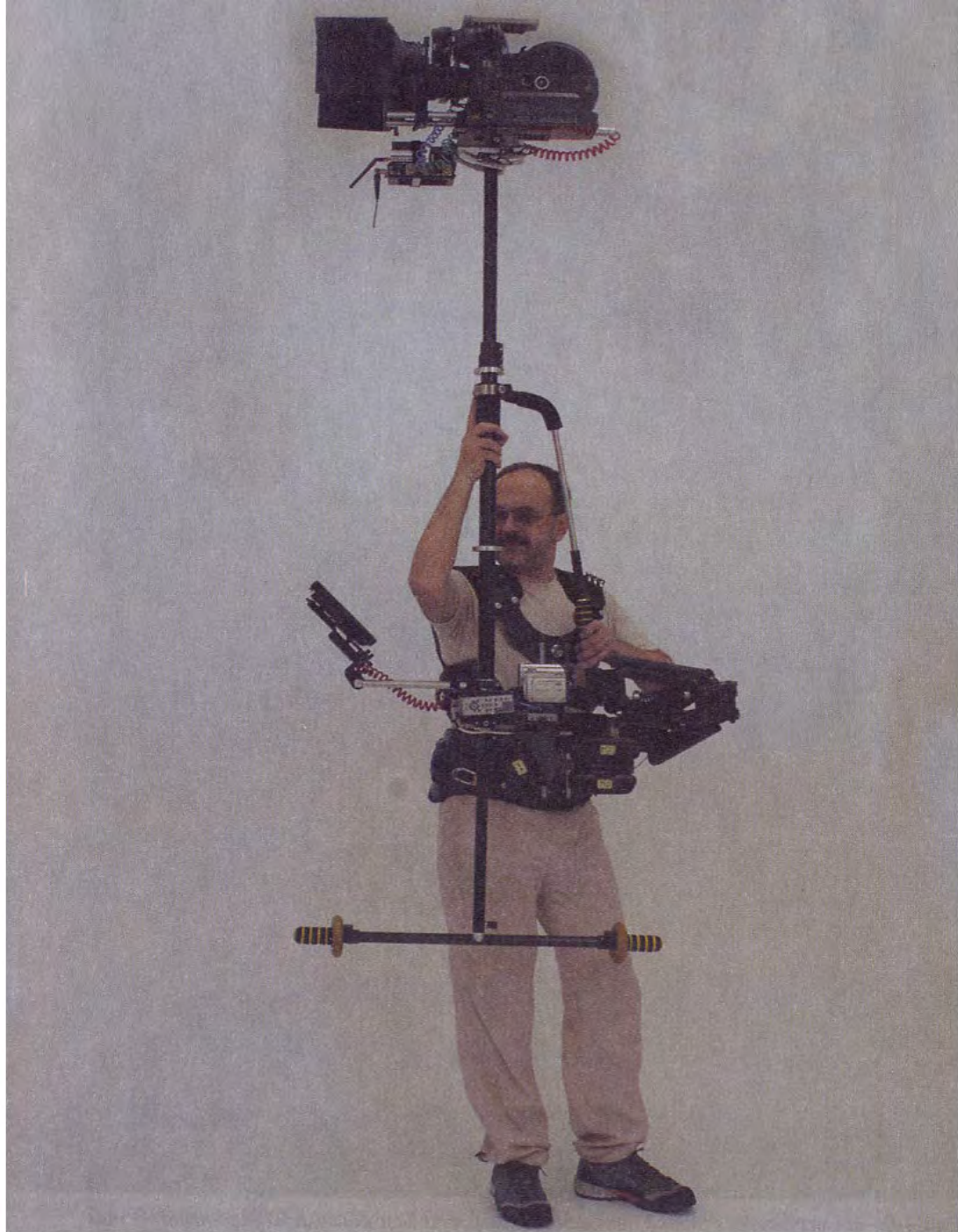
Рис.4-03-в. Сверхвысокая точка положения камеры. Консоль «супер-пост», в качестве дополнительного противовеса использована система Антлерс. Позиция «дон-жуан» - объективом назад.
