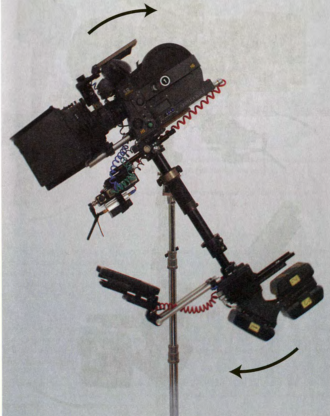
Рис.5-08-d. Регулировка «времени падения» – фаза свободного движения консоли, промежуточное положение.
