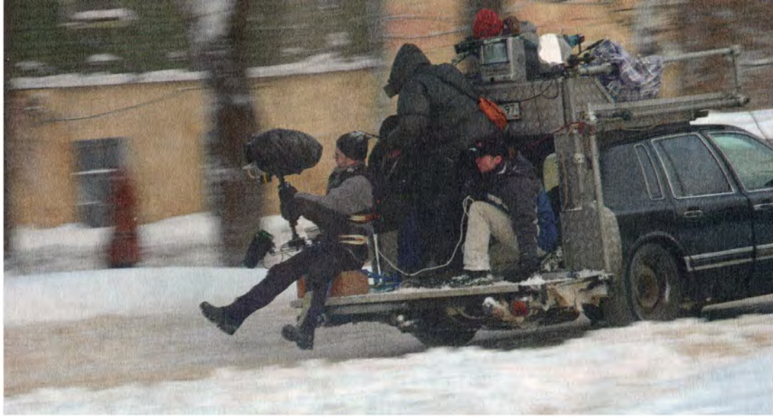
Рис.10-01. Стедикам и автомобиль. Мягкое крепление стедикама при съемке проезда применялось поскольку эпизод заканчивался сходжением оператора с автомобиля.
