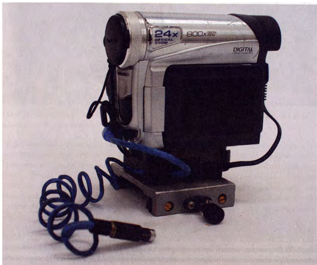
Рис.6-08. Многие в качестве «бортового» магнитофона традиционно используют миниатюрную видеокамеру с аналоговым видеовходом.
