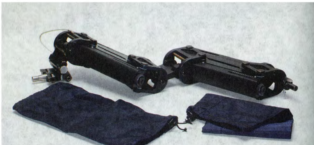
Рис.8-09. Защита руки-амортизатора обычно осуществляется с помощью двухсекционных защитных чехлов из тонкой, но плотной и непромокаемой ткани, немного напоминающих по форме распространенные в первой половине XX века «нарукавники» в среде конторских и бухгалтерских служащих.
