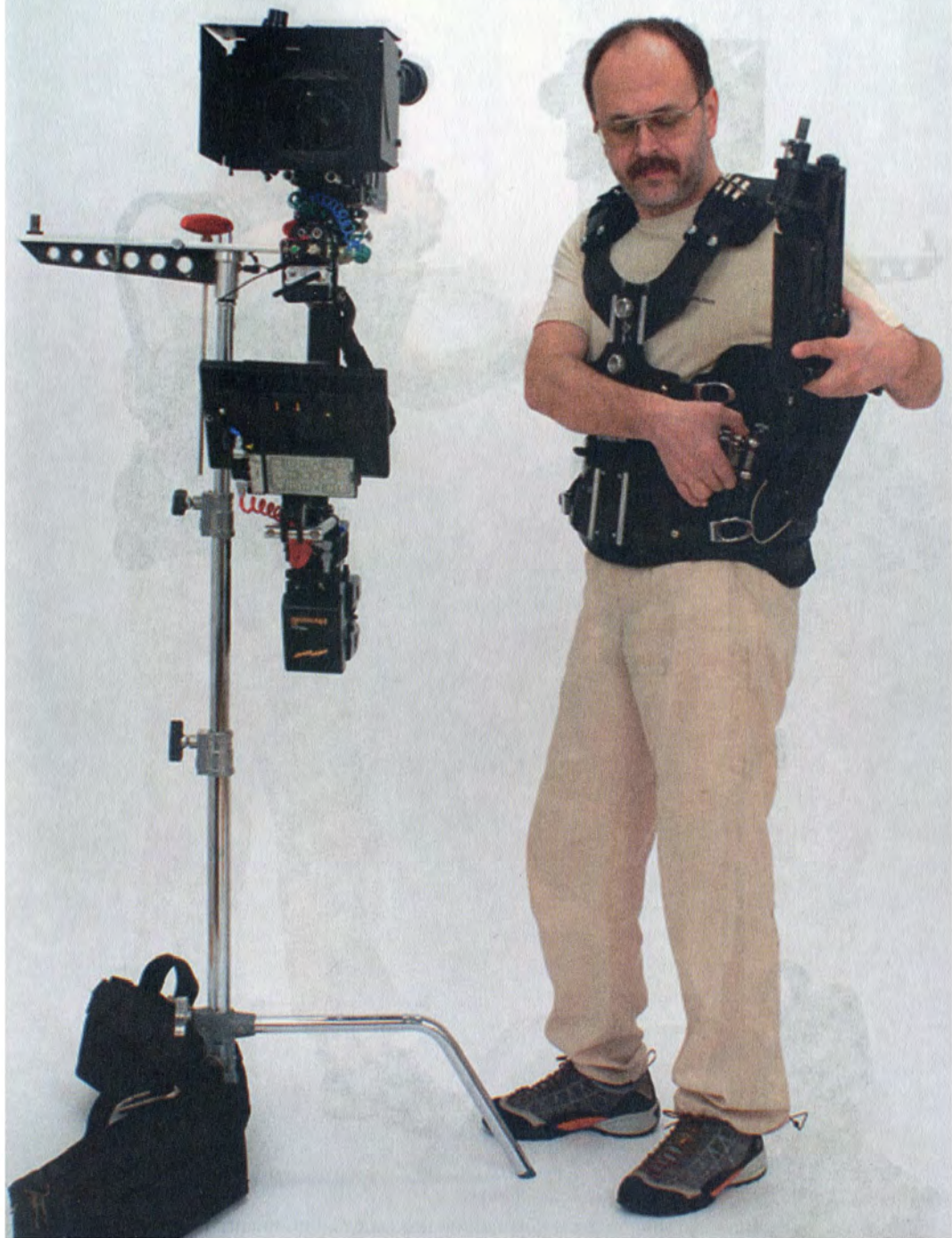
Рис.7-01- 4. Правой рукой направляем ось конического соединительного пальца параллельно оси отверстия гнезда и, вдвигая его до упора, соединяем руку с гнездом.
