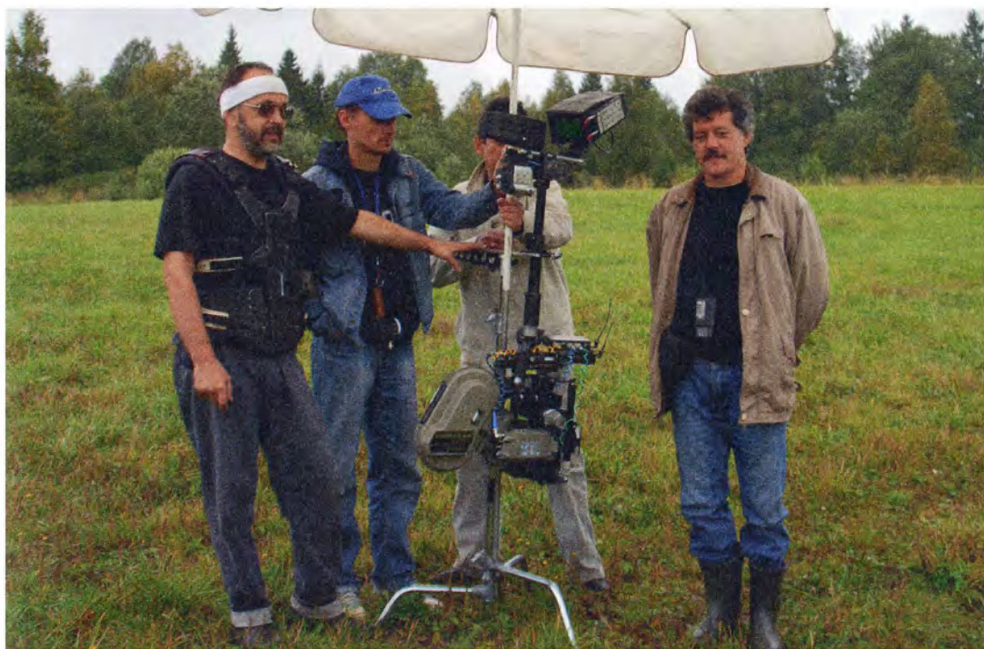
Рис.8-07. Использование большого пляжного зонта над стедикамом также защитит от моросящего дождя. (Справа – оператор-постановщик Иван Багаев, а режиссер Александр Хван пытается скрывшись за стойкой удержать зонт вместе с ассистентом по камере). Камера Moviestar SL с обычной 122-метровой кассетой закреплена снизу с помощью универсальной клетки для нижней точки для имитации субъективного взгляда бегущей овчарки.
