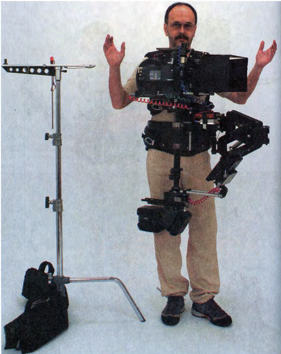
Рис.5-10-е. Правильная настройка угла наклона руки-амортизатора: при прямом положении вашего корпуса консоль находится перед вами примерно в 15-20 сантиметрах. Каждая из секций руки наклонена вниз от горизонтали на 5-10 градусов.
