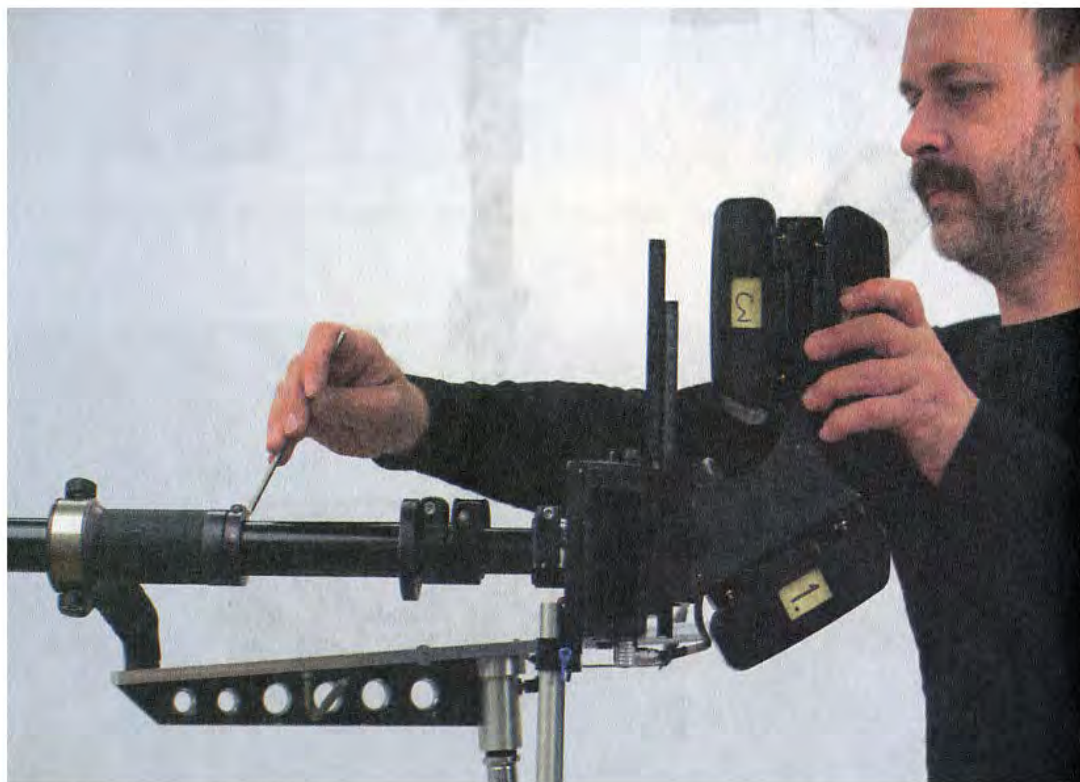
Рис.5-08-а. Регулировка «времени падения» - перемещение кардана при регулировке.
