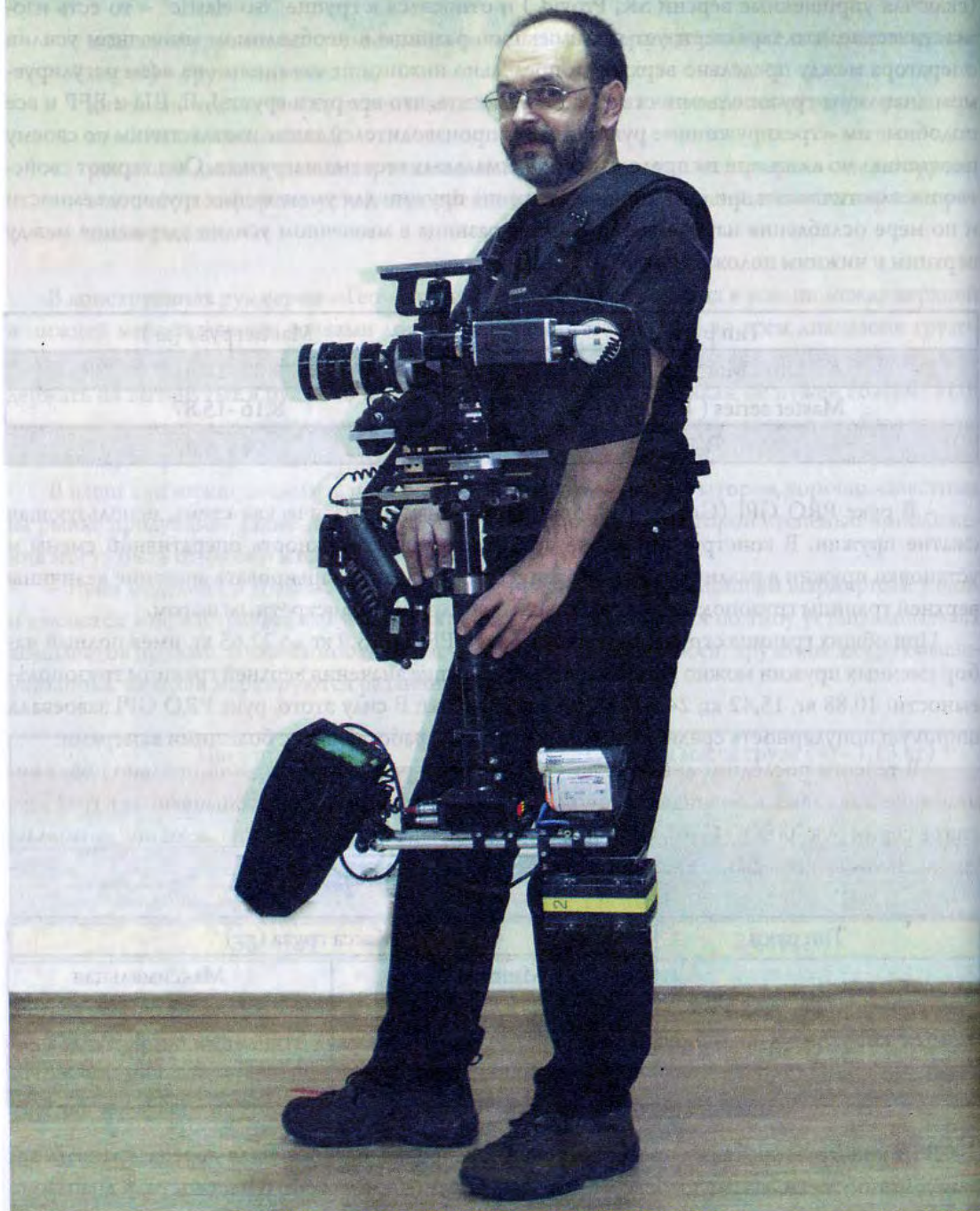
Рис.4-08-а. Возможности расширения вертикального механического диапазона перемещения камеры с применением руки-амортизатора G-50. Нижнее положение консоли.
