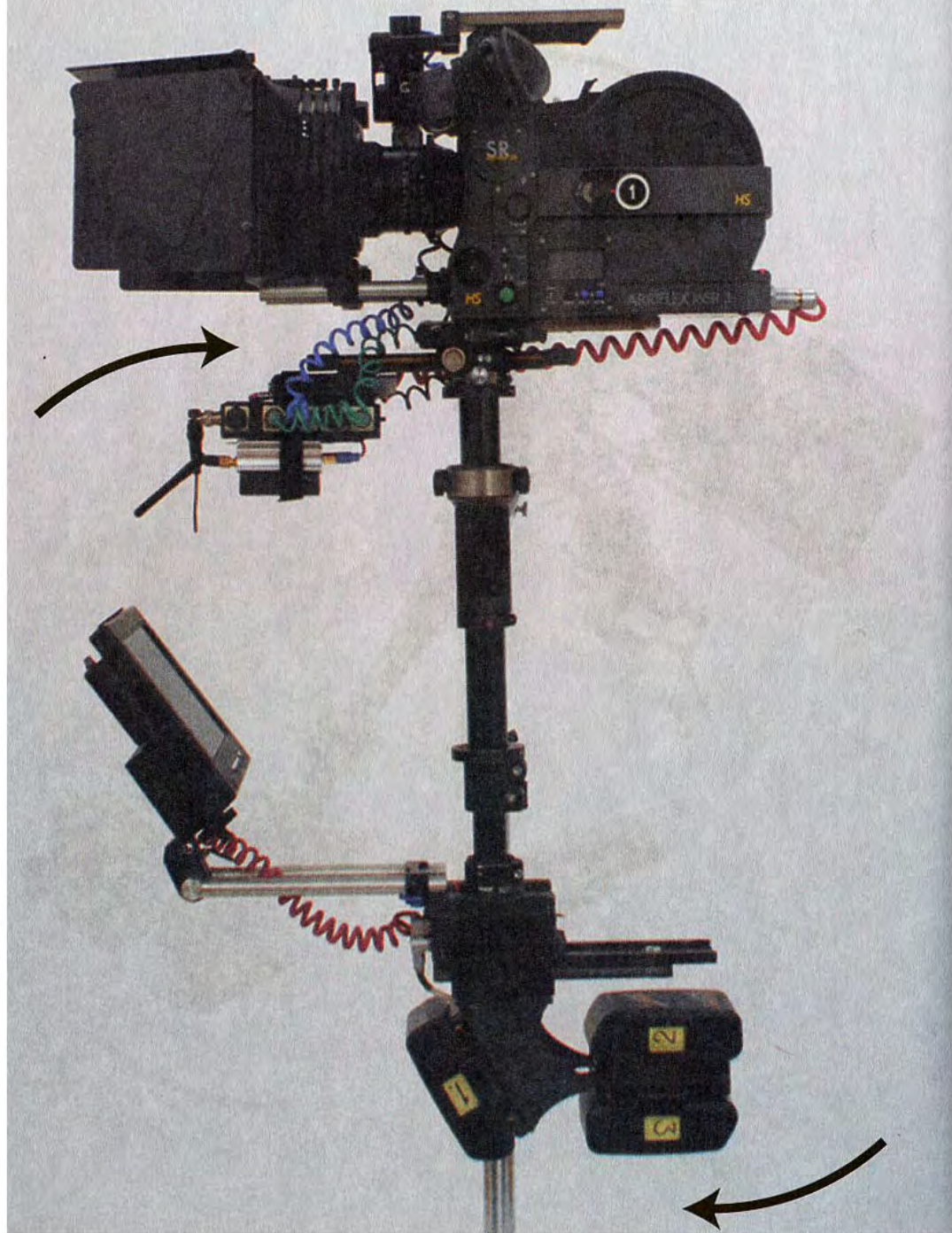
Рис.5-08-е. Регулировка «времени падения» – фаза свободного движения консоли, конечная точка отсчета времени.
