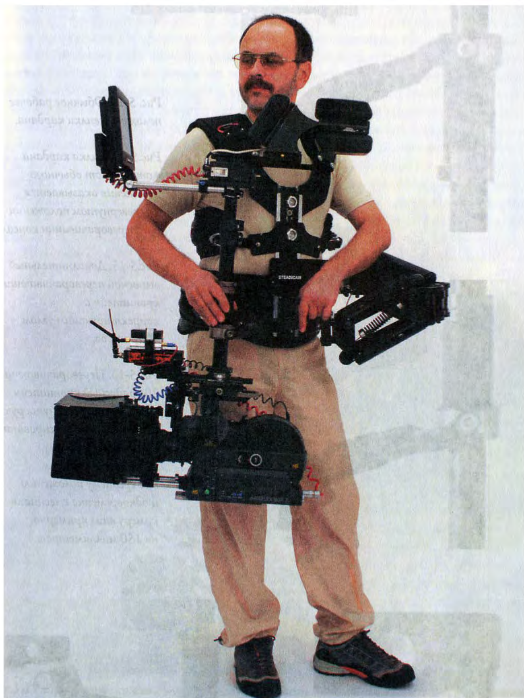
Рис.5-12. Позиция «Камера снизу» (Low mode). Монитор развернут вверх. Позиция «дон-жуан». Высота положения объектива – на уровне середины бедра.
