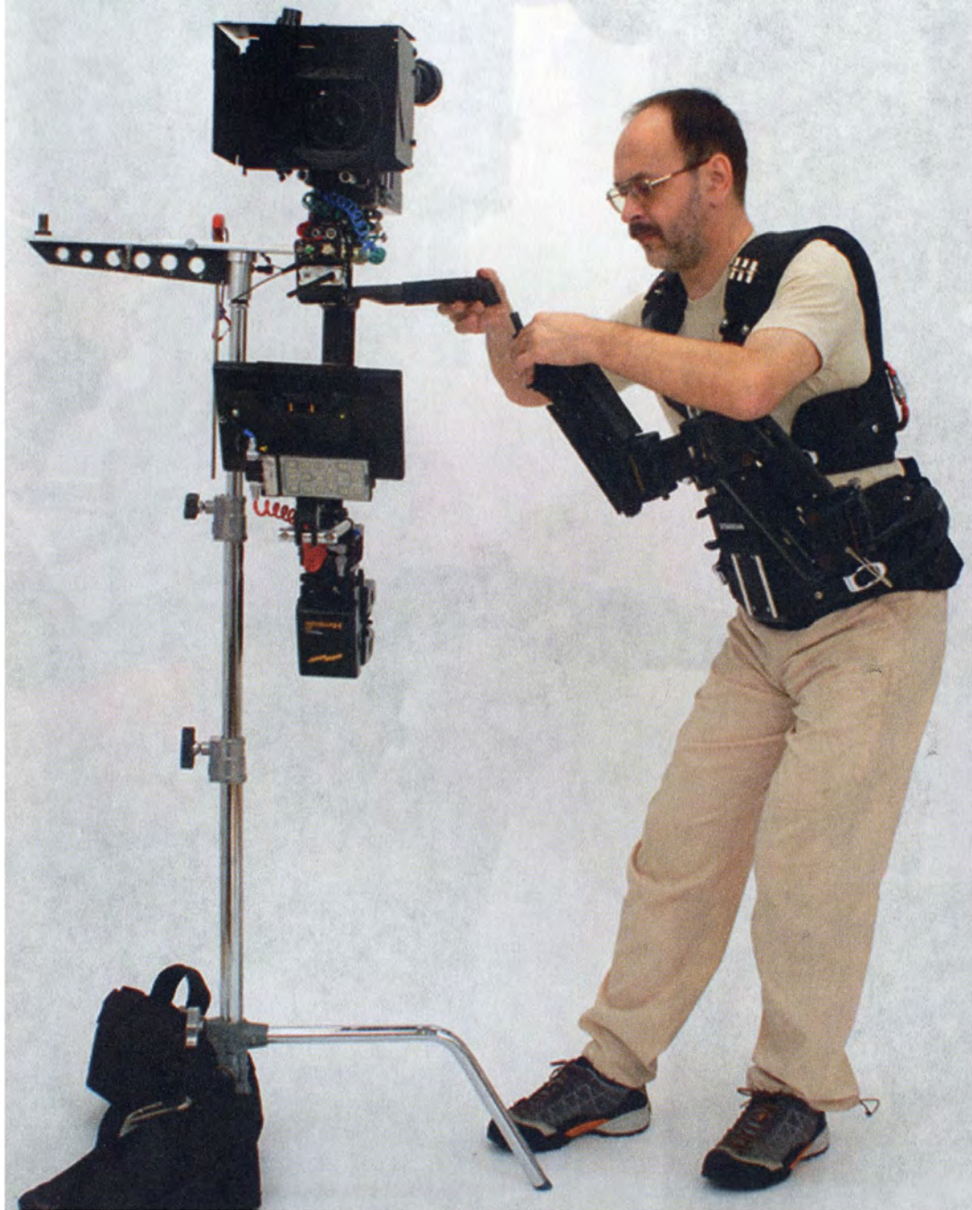
Рис.7-01-6. Руку-амортизатор направляем таким образом, чтобы оси пальца руки-амортизатора и посадочного отверстия рукоятки совпадали. Для этого правой рукой поддерживаем рукоятку вилки кардана разворачивая, при этом необходимо слегка наклонить свой корпус.
