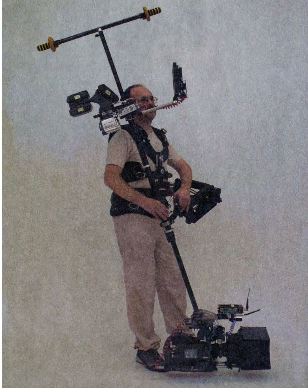
Рис. 4-04-а. Сверхнизкая точка положения камеры на базе консоли «супер-пост» - так называемая «ползущая камера». Для реализации возможности максимального приближения к объекту используется головка наклонов. В качестве дополнительного противовеса использована система антлерс. Монитор перевернут.
