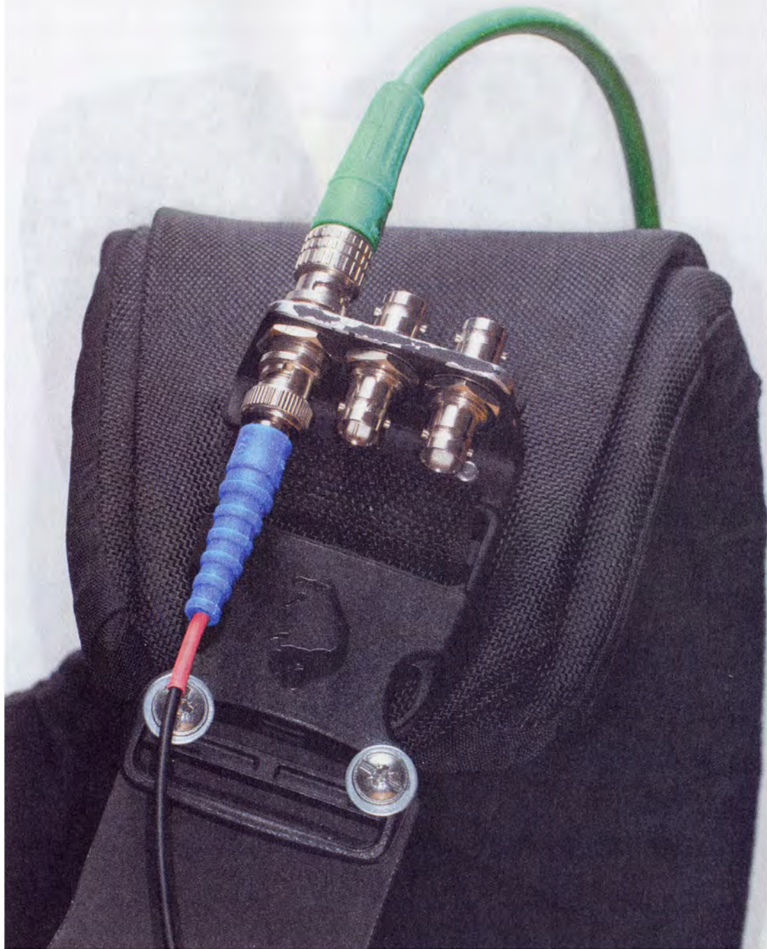
Рис.11-04. При возможности работать с составным кабелем, очень удобно для этих случаев предусмотреть специальный соединительный блок с проходными разъемами, закрепленный на плече жилета со стороны, противоположной камере.
