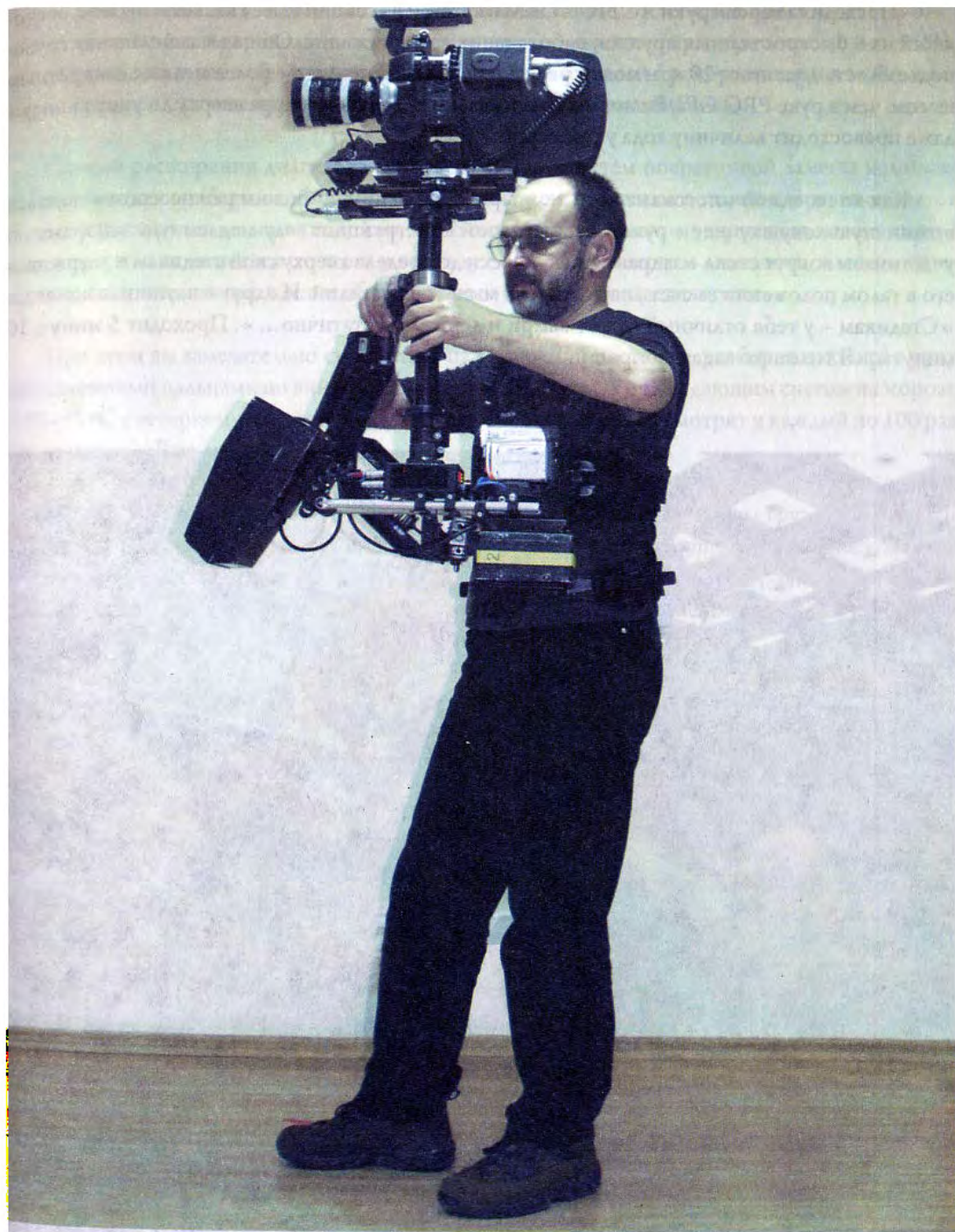
Рис.4-08-в. Возможности расширения вертикального механического диапазона перемещения камеры с применением руки-амортизатора G-50. Верхнее положение консоли.
