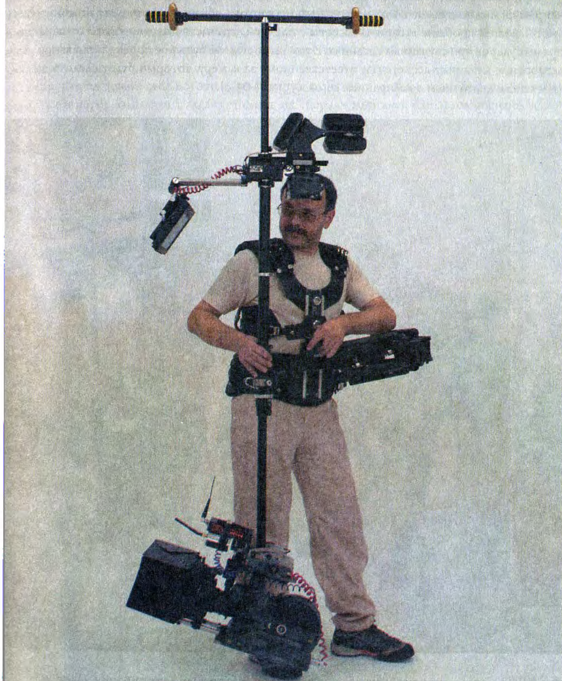
Рис.4-04-в. Сверхнизкая точка положения камеры на базе консоли «супер-пост» - так называемая «ползущая камера». В качестве дополнительного противовеса использована система антлерс. Для реализации ракурса камера развернута вверх с помощью головки наклонов. Позиция «дон-жуан» - объективом назад.
