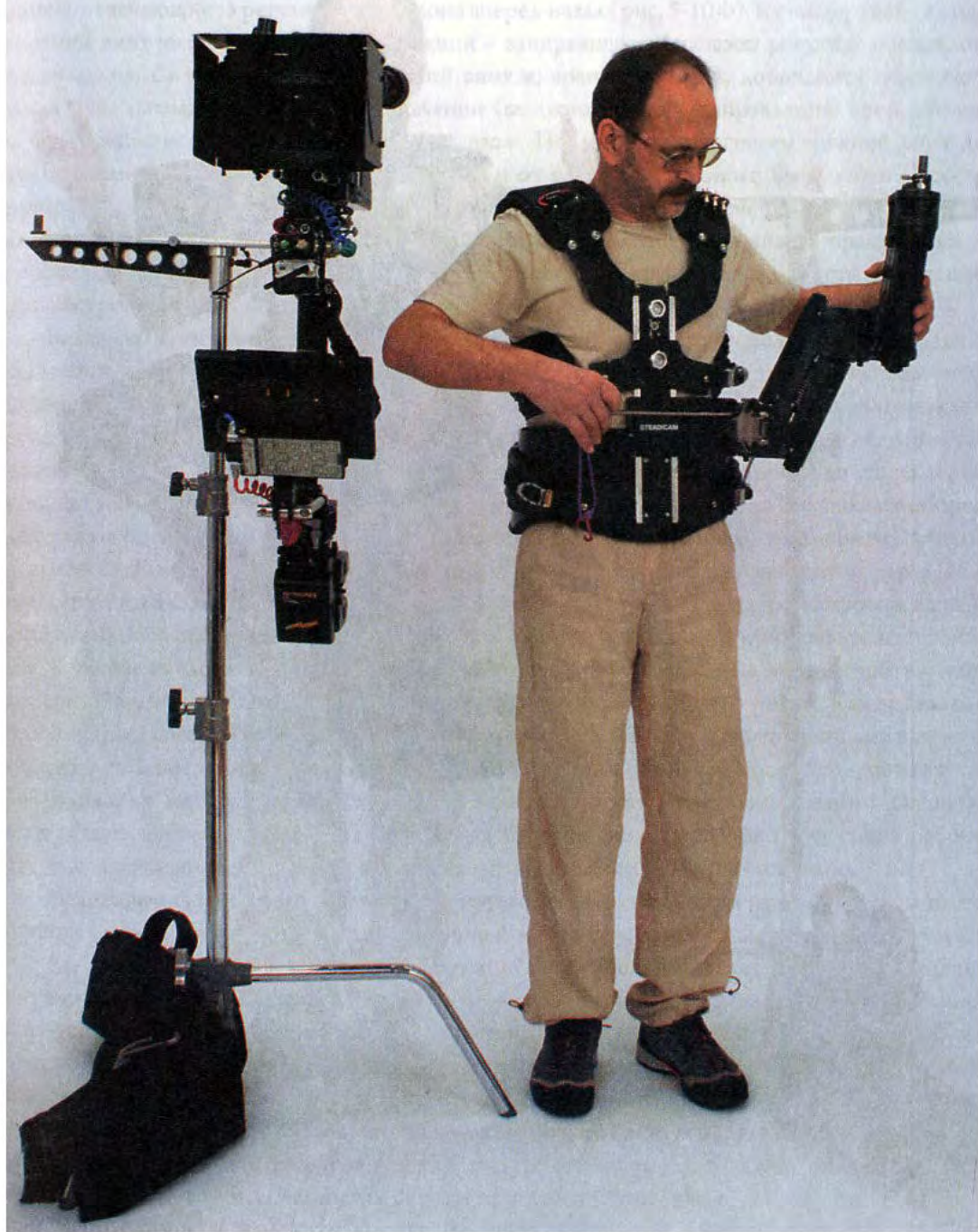
Рис.5-10-d. Регулируем наклон руки-амортизатора «вправо-влево» с помощью T-образного шестигранного ключа.
