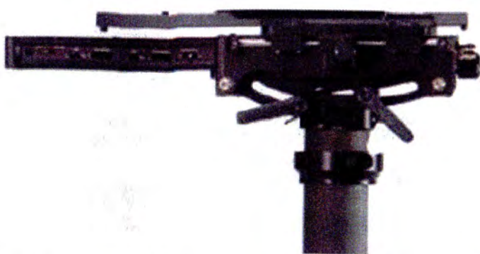
Рис.6-11. Устройство для задания наклона оси камеры относительно оси консоли.
