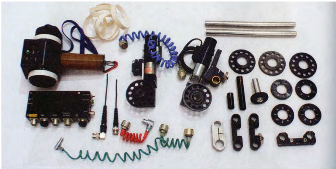
Рис.6-06. Устройство дистанционного управления объективом камеры, так называемый «радиофокус» (здесь – вариант системы, разработанной СТГ).
