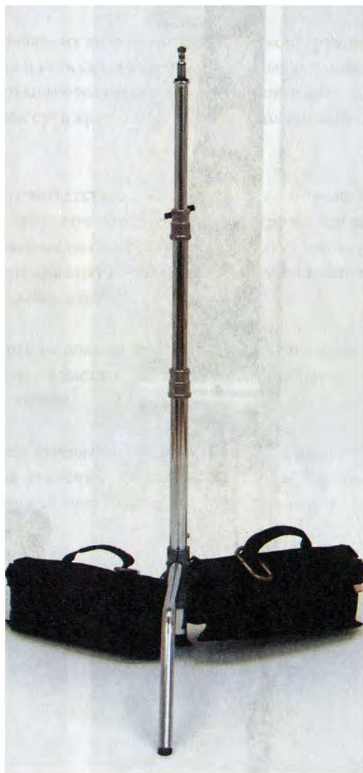
Рис.5-04-б. Штатив «си-стенд» с дополнительно загруженным основанием.
