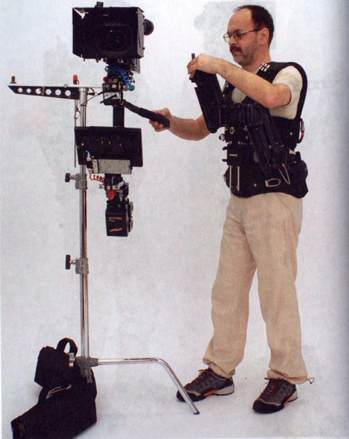
Рис.7-01-5. Перехватываем левой рукой руку-амортизатор у дальнего края дальней секции, у основания несущего пальца.
