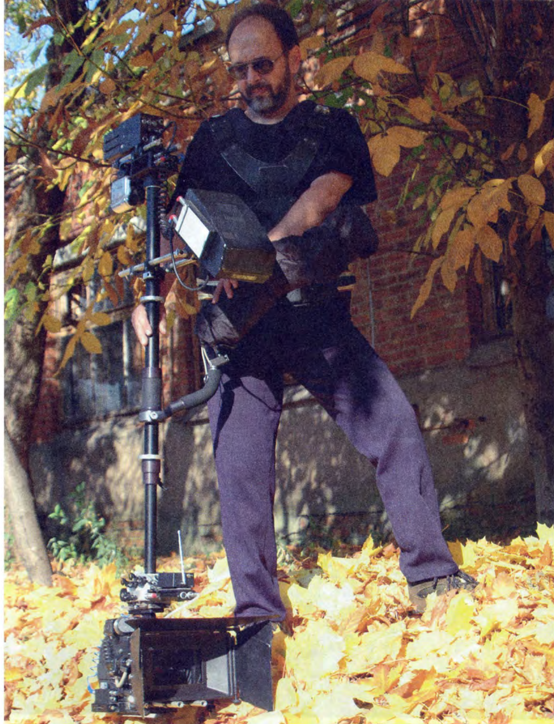
Рис.7-11. Достаточно редко употребляемый случай съемки, когда камера при вашем движении находится ниже уровня пола или паркета.
