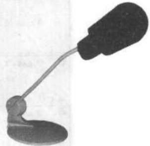
Рис. 17.8 ♦ Две поролоновые насадки помогут создать непохой звук даже с помощью дешевого микрофона
