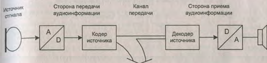
Рис. 2.10. Упрощенная схема передающей и приемной частей цифровой системы передачи звуковых сигналов
