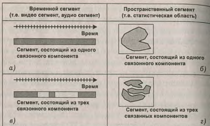
Рис. 5.15. Примеры разложения сегмента на компоненты: а и б — декомпозиции сегмента без зазоров и перекрытий; в и г — декомпозиции сегмента с зазорами и перекрытиями
