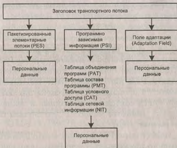
Рис. 3.22. Структура заголовка транспортного потока
