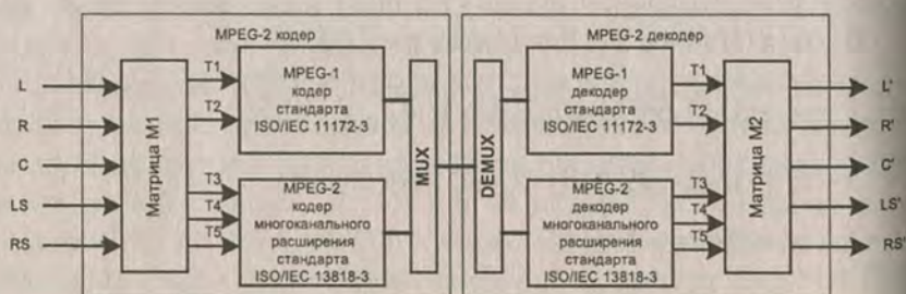
Рис. 3.23. Структурная схема кодера MPEG стандарта ISO/IEC 13818—3 (многоканальная конфигурация)
