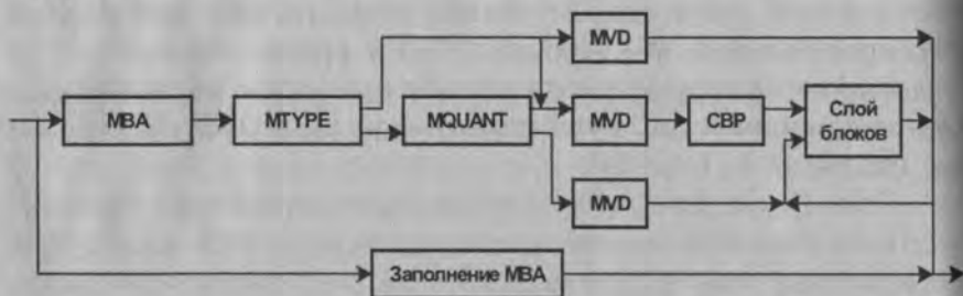
Рис. 1.4. Блок-схема кодирования и передачи изображения
