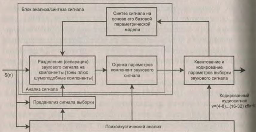
Рис. 4.15. Упрощенная схема кодера, использующего метод параметрического кодирования звукового сигнала
