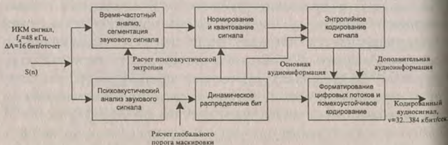
Рис. 2.11. Обобщенная структурная схема кодера источника с компрессией цифровых аудиоданных
