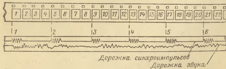
Рис. 3. Кинолента и магнитная лента после проведения синхронной записи звука одновременно со съемкой фильма.
