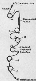
Рис. VIII.1. Схема лентопротяжного тракта кинопроектора
