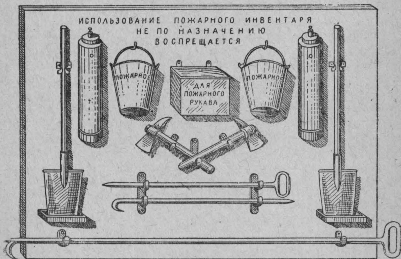
Рис. 44. Простейшее оборудование пожарного щита.
