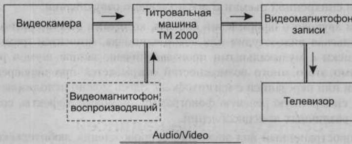
Рис. 20.2. Соединение аппаратуры при простом линейном монтаже
