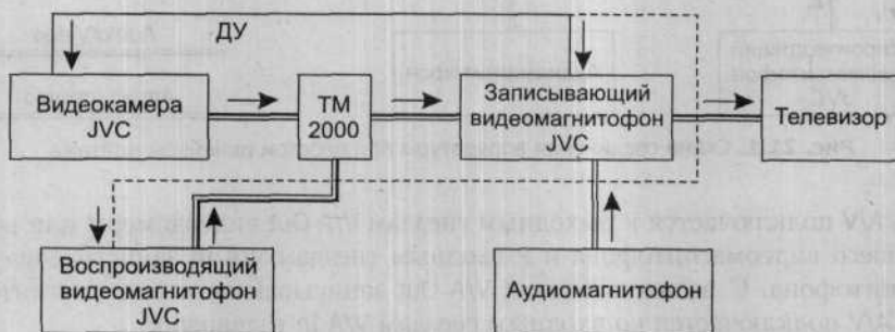
Рис. 21.2. Схема соединения аппаратуры при простом линейном монтаже с применением титровальной машины TM-2000
