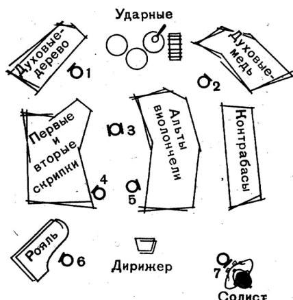
Рис. 30. Схема расположения солиста, оркестра и микрофонов
