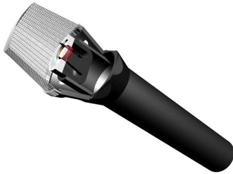
Рис. 4.4: Внешний вид электродинамического микрофона (в разрезе).
