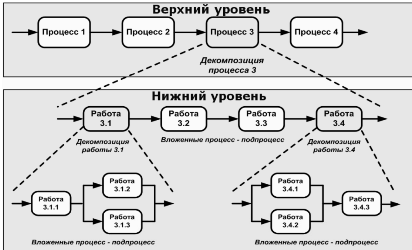
Принцип декомпозиции при разработке цепочек процедур
