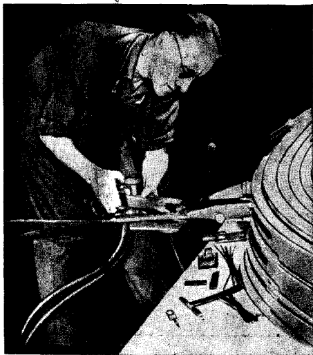
Фиг. 9. Пайка сопротивлением при помощи клещей.
