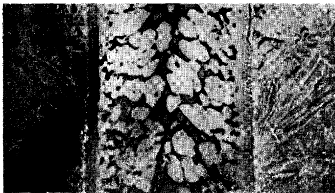
Фиг. 82. Соединение из титана, паянное припоем BAg-1a (травление 20% \text{HNO}_3 + 20\% \text{ HF} + 60\% \text{ глицерина} ). \times 500 .
