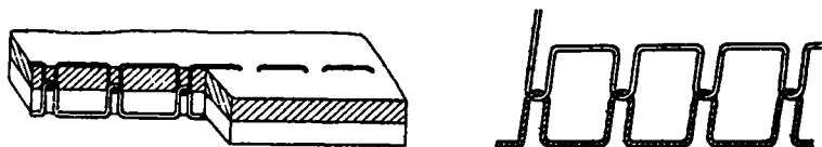
Рис. 76. Строчка челночного линейного стежка
