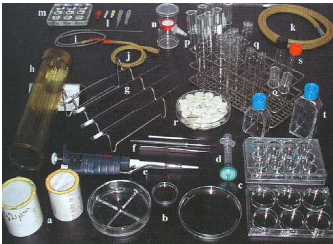
Рис. 13. Посуда и оборудование для выделения водорослей (Andersen, Kawachi, 2005): а - сита для удаления животных и крупных водорослей; б - стеклянные и пластиковые чашки Петри; с – пластиковые планшеты; d - шприц с фильтром с диаметром отверстий 0,2мкм; е –микропипетка с дозатором; f - маленькая лупа, микробиологическая петля и пинцет; g - пипетки Пастера, установленные на металлической стойке; h – стерильные пипетки Пастера в пластиковом футляре; i - стеклянная трубочка, маленький шланг и соединительная трубка; j - мундштук для соединения шлангов во время изоляции, маленький соединительный шланг для пипетки Пастера; k – большой соединительный шланг с наконечниками пластиковой пипетки на обоих концах, один конец служит мундштуком, другой поддерживает пипетку Пастера; l - мундштуки и два наконечника пластиковых пипеток, которые могут быть использованы как мундштуки; m - стеклянная планшета, которая может быть использована для споласкивания клеток во время выделения; n - маленький аппарат для фильтрования; o - стеклянные пробки как для гладких пробирок, так и пробирок с резьбой для крышек; p - гладкие стеклянные пробирки со стеклянными пробками; q - пробирки со специальной резьбой для крышек; r – стерильные пробки для пробирок; s – пластиковые пробирки с крышками, стерилизованные промышленным способом; t - стерильные колбы для культивирования с крышками.
