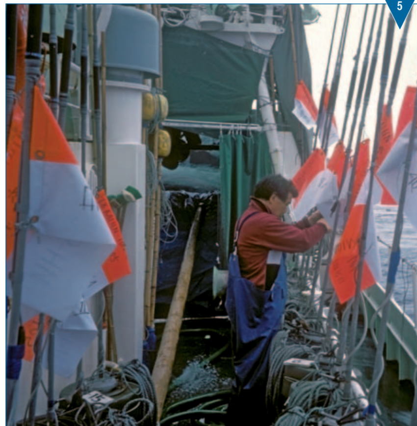
Рис. 5. Проверка радиобуев перед постановкой дрейферных порядков
