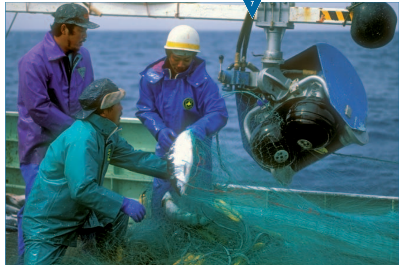
Рис. 7. Выборочная лебедка верхней подборы дрейферного порядка
