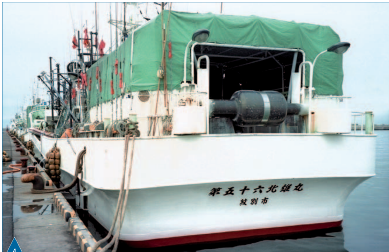
Рис. 4. Рол на корме судна для выметки сетей
