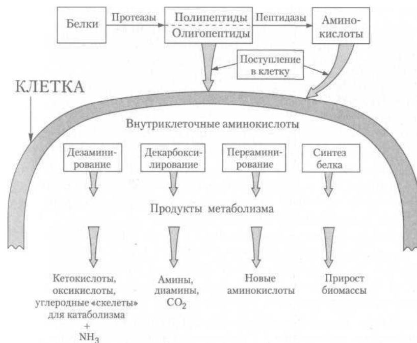
Рис. 1.27. Аммонификация (минерализация) белковых соединений микробной клеткой [по: Бабьева, Зенова, 1989]
