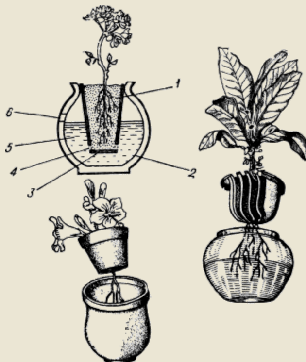
Рис. 4. Растения в двойных вазонах: 1 – субстрат; 2 – наружная керамическая ваза; 3 – цветочный горшок; 4 – боковые дренажные отверстия; 5 – питательный раствор; 6 – контрольные отверстия.
