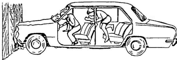
Рис. 273. Механизм инерционного перемещения тел водителя и пассажира кабины легкового авто- мобиля при его столкновении с препятствием.
