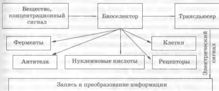
Рис. 7.4. Схема биосенсора (по С.Д. Варфоломееву, 1997)
