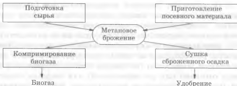
Рис. 6.3. Блок-схема производства биогаза (по В.В. Бирюкову, 2004)
