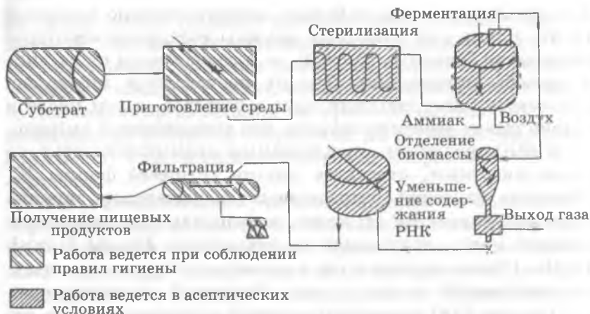
Рис. 6.6. Блок-схема производства микопротеина (по И. Хиггинсу и др., 1988)
