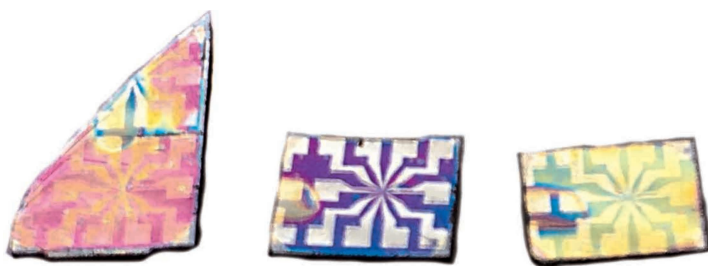
Рис. 6.10. Образцы мемристорных кроссбаров на основе пленки оксида титана. Цвет пленки зависит от доли примеси алюминия в оксиде
