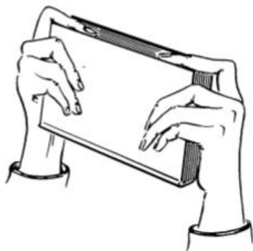
Рис. 7. Выравнивание блока в крышке
