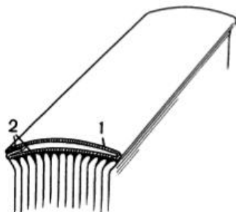
Рис. 2. Приклейка гильзы к кругленому и кашированному корешку блока: 1) гильза, 2) клей
