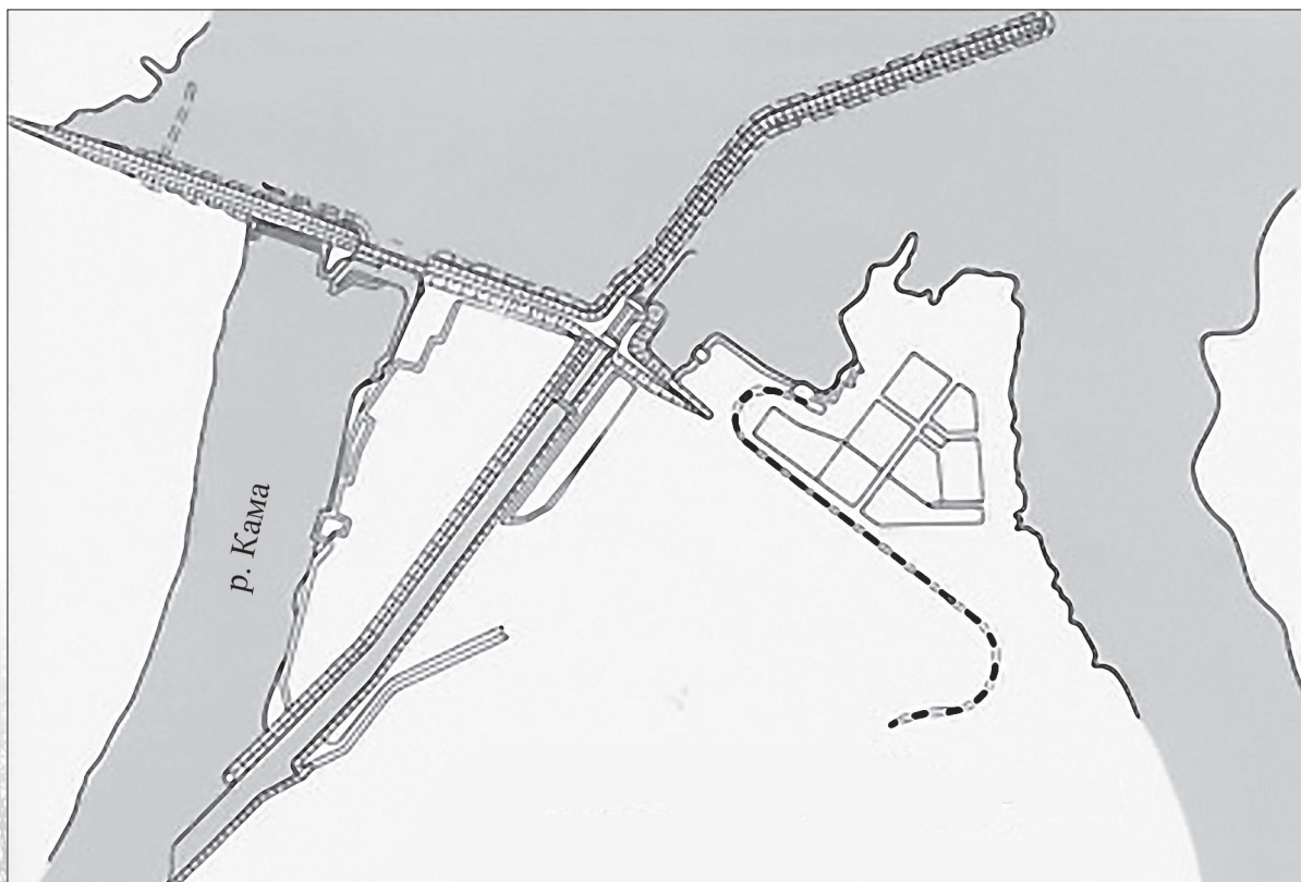
План сооружений Воткинского гидроузла
