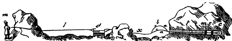
Схема электропроводки для производства взрыва при горных разработках.
