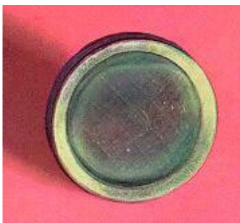
14.56. Тонкая пленка металлического полония на диске из нержавеющей стали. 588
