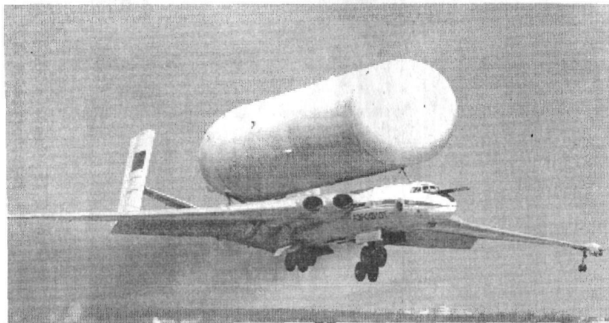
Рис. П.14. Самолет ВМ-Т “Атлант” с отсеком ракеты “Энергия”
