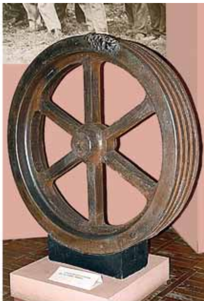
Экспонаты Дома-музея Н.Г. Славянова: электроплавильник; шквив, отремонтированный по методу Славянова.
