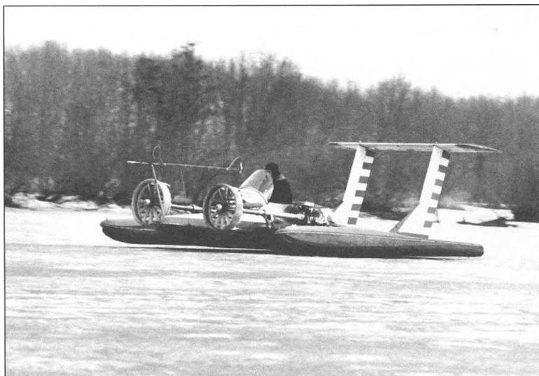
Зимние испытания предшественника пассажирского экраноплана («Волга-2») на ИС-2
