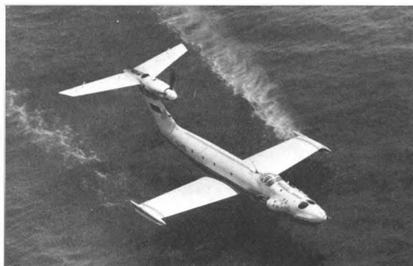
Самоходная модель СМ-6 на испытаниях
