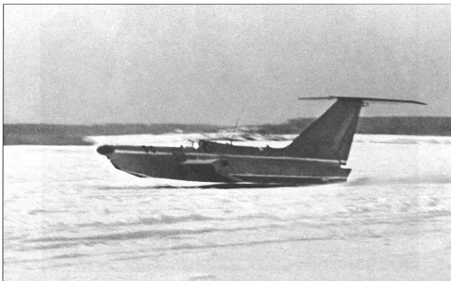
Самоходная модель СМ-3 на испытаниях. Внизу фото А. А. Беляева
