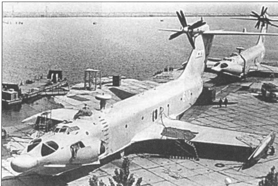
Десантные экранопланы «Орленок» на базе в Каспийске
