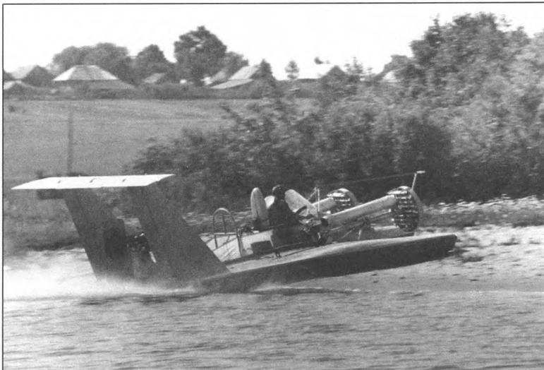
Летние испытания предшественника пассажирского экраноплана («Волга-2») на ИС-2
