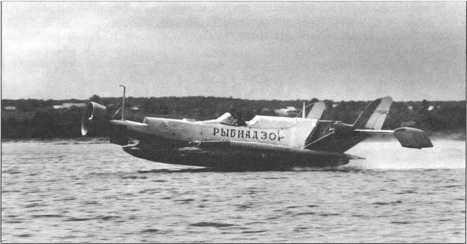
Один из вариантов самоходной модели экраноплана СМ-9
