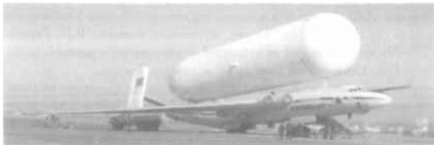
Авиационная транспортировка бака горючего второй ступени ракеты-носителя «Энергия» с завода-изготовителя на космодром
