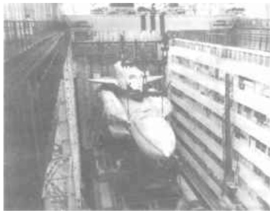
Перегрузка системы «Энергия-Буран» на транспортно-установочный агрегат
