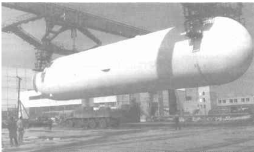
Установка бака горючего второй ступени ракеты-носителя «Энергия» на самолет-транспортировщик ЗМТ
