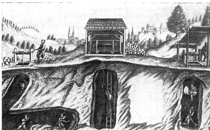
Разрез рудника с применением ручных ворот для доставки руды. Иллюстрация из книги И. А. Шлаттера «Обстоятельное наставление рудному делу»
