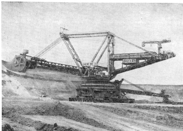
Мощный роторный экскаватор «пятитысячник» на марганцево-рудном карьере
